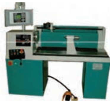
شکل ۲۸- نمونه‌ای از دستگاه بوبین پیچ
