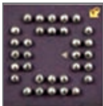
شکل ۲۱- تصویر ظاهری انواع پکیج‌های BGA
