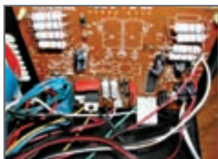
شکل ۱۳۲- برد الکترونیکی و کنترل شدت هوای فشرده
