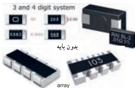
شکل ۱-۳۷- مشخصات چند نمونه مقاومت SMD پایه‌دار و بدون پایه و چگونگی نصب آن
