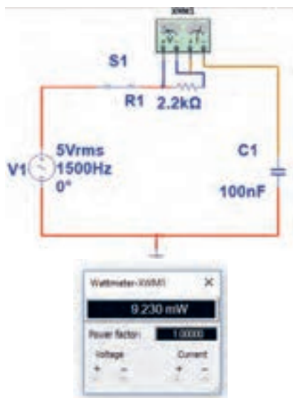
شکل ۵۰ - مدار با وات متر
