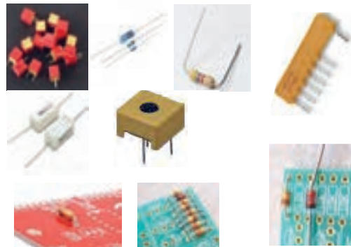
شکل ۱-۳۶- مشخصات چند نمونه دیگر قطعات TH و چگونگی نصب آن
