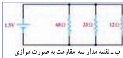
شکل ۶۶-۱ - سه مقاومت به صورت موازی
