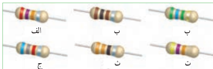
شکل ۸۰-۱- خواندن کد رنگی مقاومت‌ها
