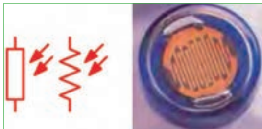
شکل ۹۵ — ۱ مقاومت تابع نور و نماد آن
