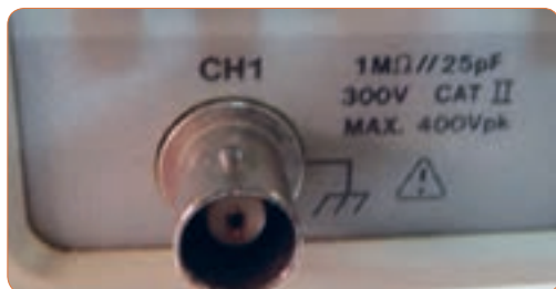
شکل ۷۲-۴- ورودی اسیلوسکوپ
