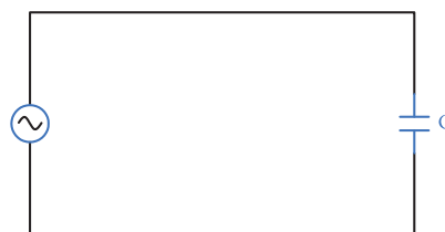
شکل ۳۰-۵ مدار خازنی خالص
