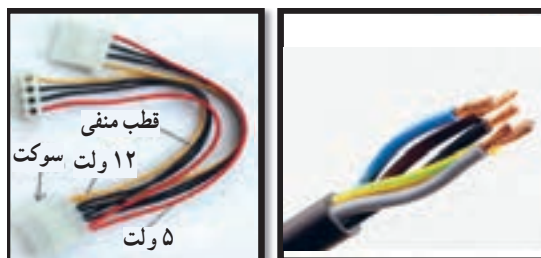
کابل‌های چند رشته‌ای برای اتصال به سوکت
