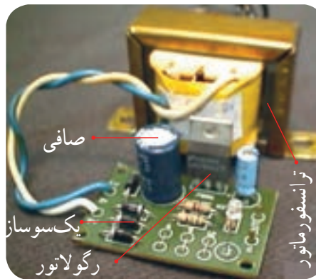
شکل ۶۵-۶ بلوک دیاگرام منبع تغذیه و مدار واقعی آن
