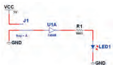
شکل ۵۹-۶ مدار گیت منطقی NOT
