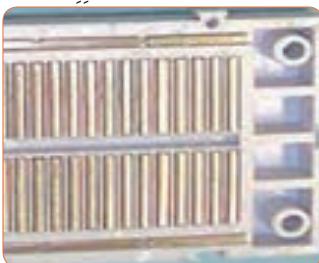
شکل ۸۹- ۱- اتصالات داخلی بُرد بُرد
