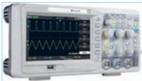
شکل ۵۴-۴- یک نمونه اسیلوسکوپ با صفحه نمایش LCD
