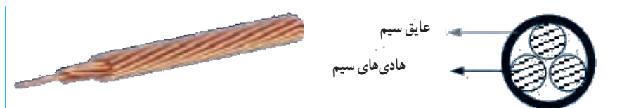
شکل ۱۱ - ۲ - سطح مقطع سیم نیمه افشان
