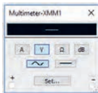
شکل ۳۷-۴ تنظیم مولتی‌متر برای اندازه‌گیری ولتاژ AC
