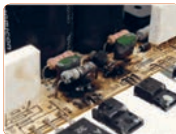
شکل ۲۴-۵ - آسیب قطعات در یک برد
