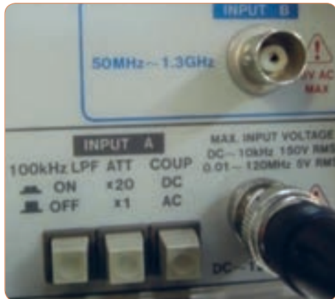
شکل ۴۹-۴ ورودی‌های فرکانس متر دیجیتالی
