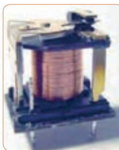
شکل ۳۴-۶- ساختمان داخلی دو نوع رله
