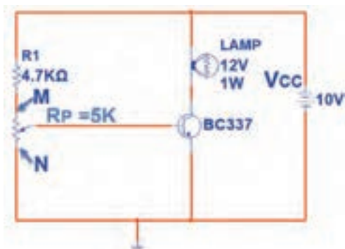
شکل ۴-۱۱- مدار آزمایش هدایت ترانزیستور
