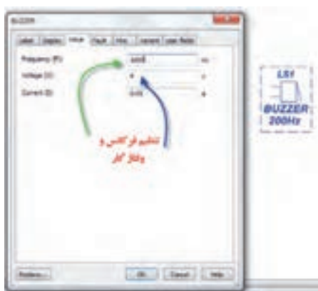
شکل ۶-۲۵- تنظیم فرکانس و ولتاژ کار بی‌زر
