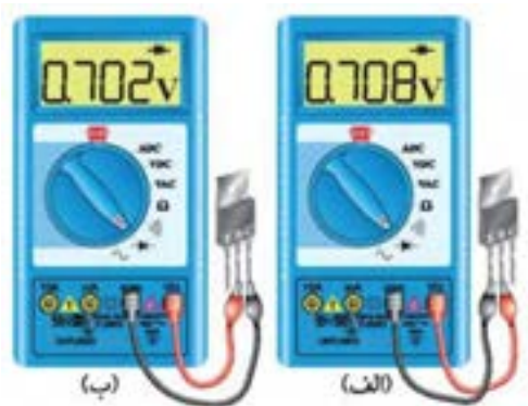
شکل ۴-۴- ولتاژ موافق کلکتور- بیس و امیتر- بیس
