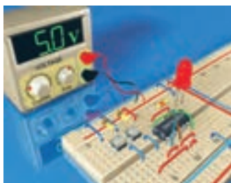
شکل ۷-۴- بستن مدار روی بردبرد و آزمایش آن
