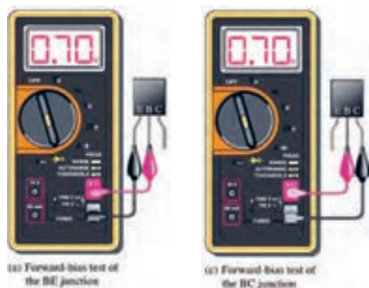
شکل ۴-۳- تشخیص پایه بیس ترانزیستور با مولتی‌متر دیجیتالی
