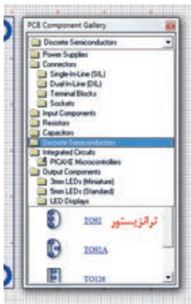
شکل ۴۹-۶- انتخاب پایه‌های ترانزیستور BC547
