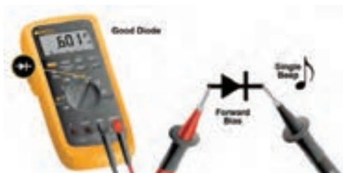
شکل ۳-۶- وضعیت تست دیود در بایاس موافق
