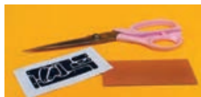
شکل ۷-۷- برش طرح مدار چاپی از کاغذ
