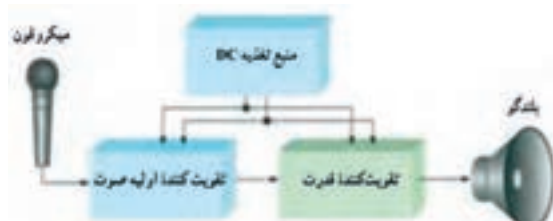
شکل ۴-۱۷- بلوک دیاگرام آمپلی فایر صوتی
