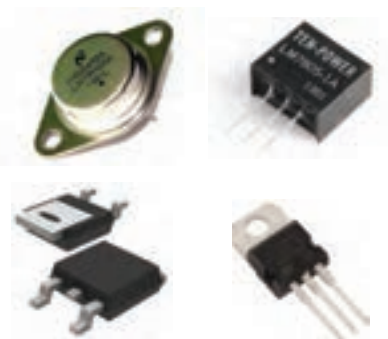
شکل ۷۲-۳- بسته بندی آی‌سی‌های رگولاتور
