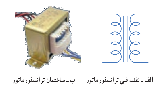
شکل ۳۹-۳- نقشه فنی و ساختمان یک ترانسفورماتور
