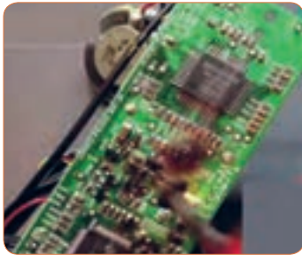
شکل ۵-۵ - قطعاتی از برد سوخته است.
