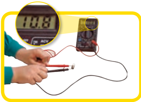
شکل ۸- اندازه‌گیری مقاومت لامپ خاموش با اهم سنج
