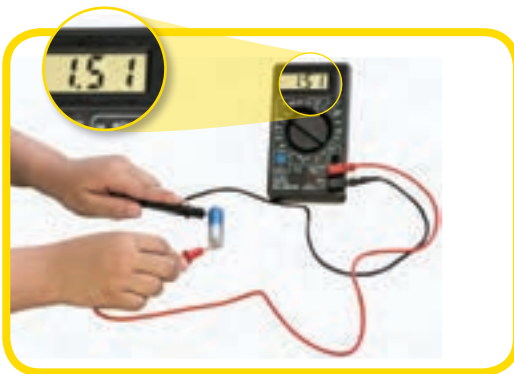
شکل ۶- اندازه‌گیری اختلاف پتانسیل دو سر باتری
