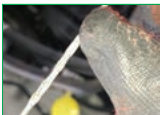
ح- میله اندازه‌گیر روغن موتور را مجدداً کنترل کنید.
