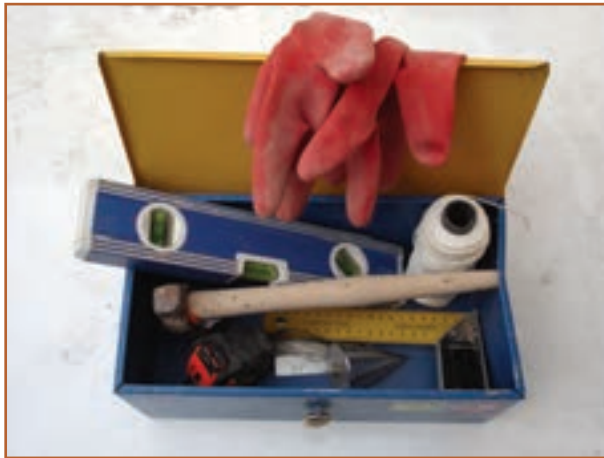
شکل ۱۰-۷- برخی از ابزار مورد نیاز دیوار چینی
