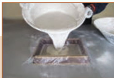
ث - ریختن ملات گچ در قالب
