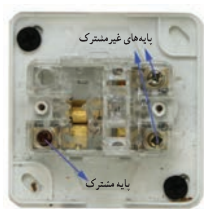
شکل ۵-۱۹- نمای داخلی یک نمونه کلید تبدیل
