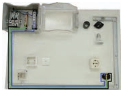
شکل ۵-۱۰- انجام سیم‌کشی پریز ۱
