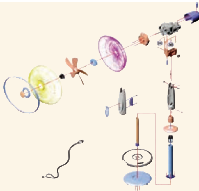
شکل ۱۲-۱- اجزاء سیستم پنکه
