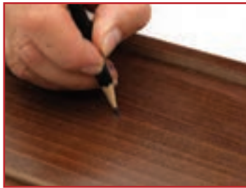
ب- مشخص کردن مرکز در با مداد
