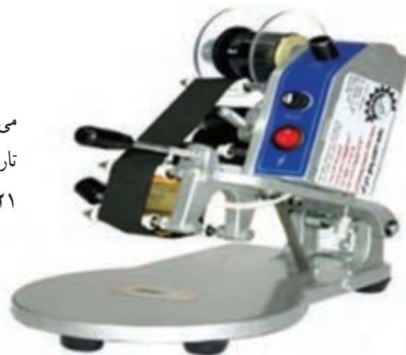
شکل ۱۱-۲۱- دستگاه برچسب‌زنی حبوبات
