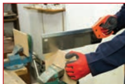
الف- بریدن قطعات با اره ظریف بر
