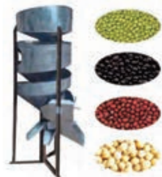
شکل ۱۱-۱۸- دستگاه درجه بندی حبوبات
