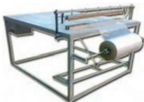
شکل ۱۱-۲۰- دستگاه بسته بندی اولیه حبوبات
