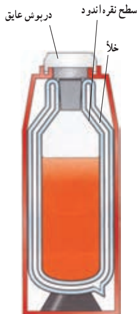
شکل ۱۳- دمابان (فلاسک) خلأ می‌تواند مدت نسبتاً زیادی دمای جسم را تقریباً ثابت نگه دارد.
