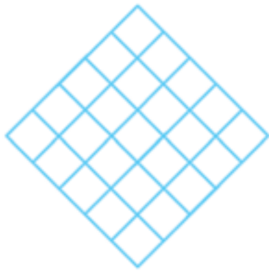
شکل ۶-۱۶ کشیدن خط آزاد ۴۵ درجه
