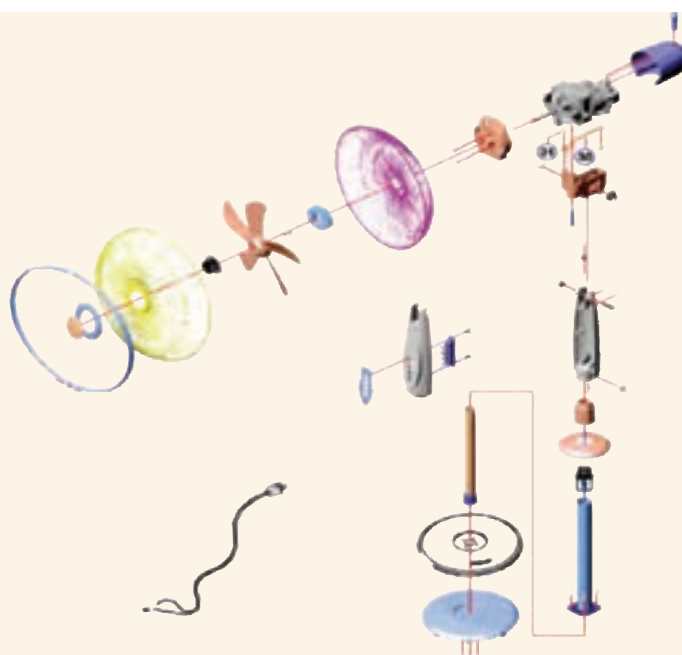
شکل ۱۲-۱- اجزاء سیستم پنکه
