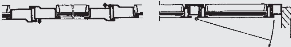
شکل ۹-۲۲- چند نمونه پروفیل‌های نورد شده برای در و پنجره
