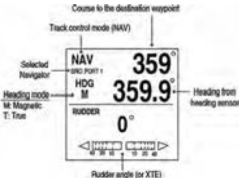
شکل ۹- نمایشی از مد NAV در سیستم اتوپایلوت AP500
