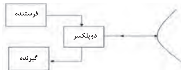
شکل ۲- بلوک دیاگرام یک رادار ابتدایی
