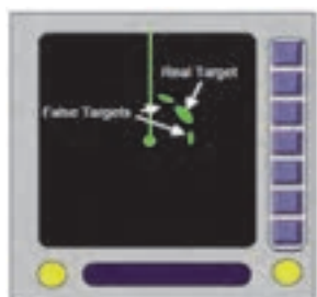
شکل ۱۶- نمایش پژواک‌های جانبی در صفحه نشانگر رادار
