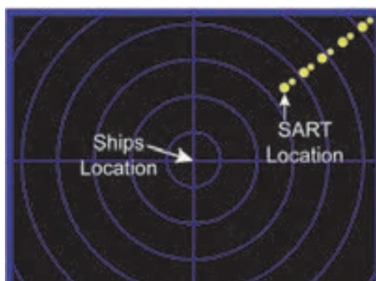
شکل ۱۹- SEARCH AND RESCUE TRANSPONDER
