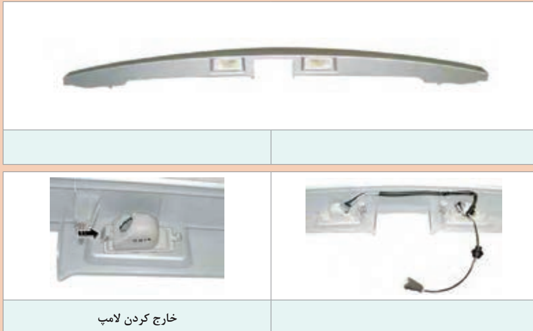
شکل ۳۵- روش باز کردن و بستن چراغ پلاک
