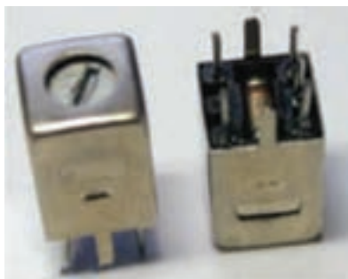
ترانس IF و خازن داخل آن
