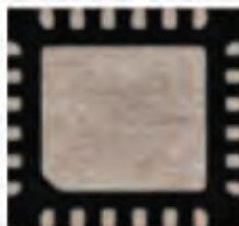
تصویر ظاهری انواع پکیج های DFNT, DFN
