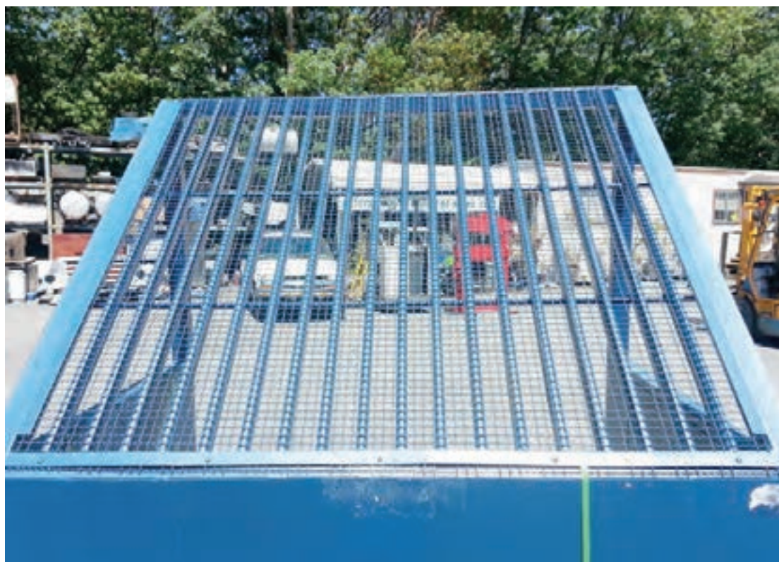
شکل ۳- سرنند ثابت
