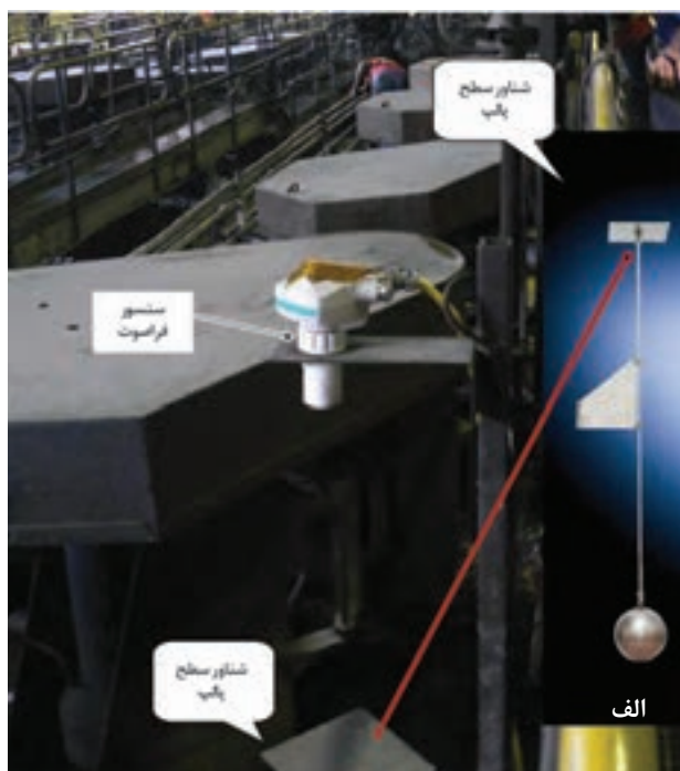
شکل ۴۱- الف) تجهیزات اندازه‌گیری عمق کف در سطح سلول فلوتاسیون، ب) شیر تخلیه سوزنی و پیستون آن
