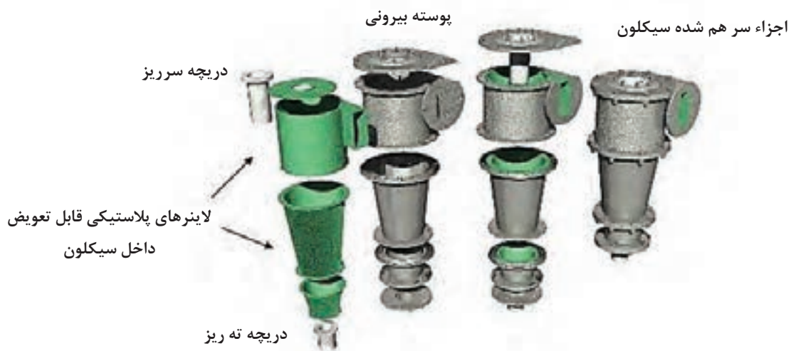
شکل ۲۱- اجزاء تشکیل دهنده سیکلون
