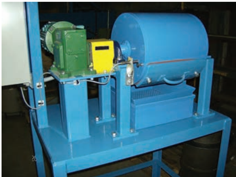
شکل ۲- آسیای گلوله ای آزمایشگاهی باند
