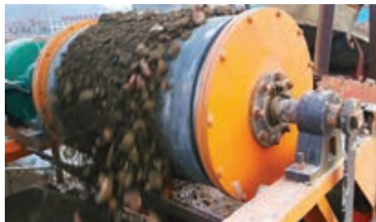
شکل ۲۴- غلتک مغناطیسی
