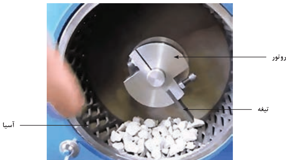
شکل ۳- نمای داخلی آسیای استاندارد ساینده‌ی باند
