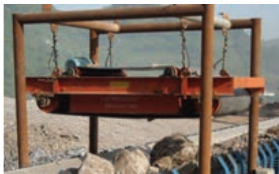
شکل ۲۶- جدا کننده های مغناطیسی معلق نوار متقاطع
