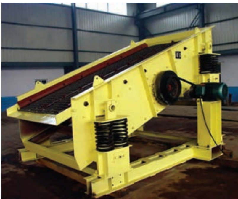
شکل ۵- سرندهای با حرکت نوسانی
