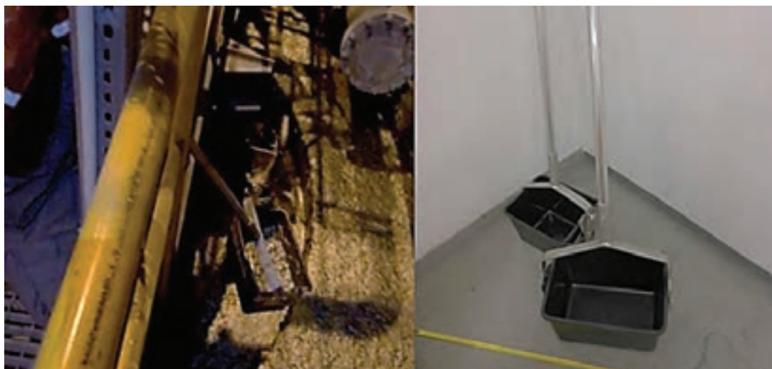
شکل ۳۴- تجهیزات نمونه گیری از سرریز سلول فلوتاسیون
