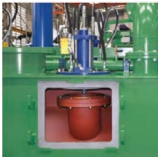
شکل ۱۰ - شیرهای دیسکی
