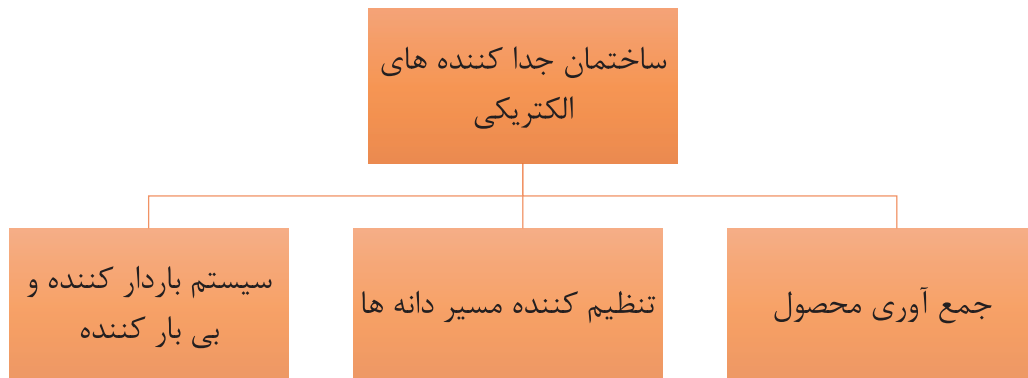
شکل ۳۷- ساختمان جداکننده‌های الکتریکی
