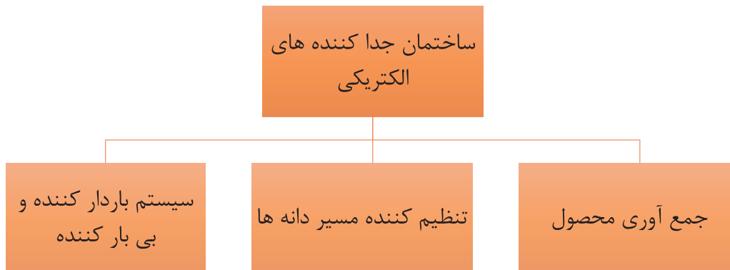
شکل ۳۷- ساختمان جداکننده‌های الکتریکی
