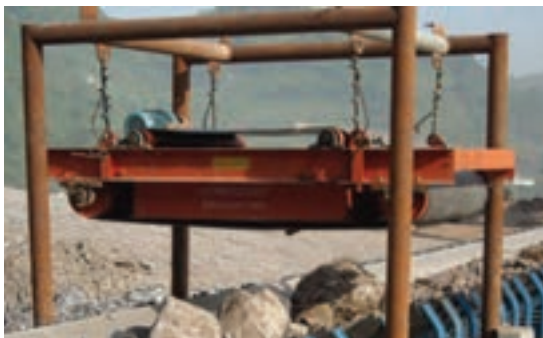
شکل ۲۶- جدا کننده های مغناطیسی معلق نوار متقاطع
