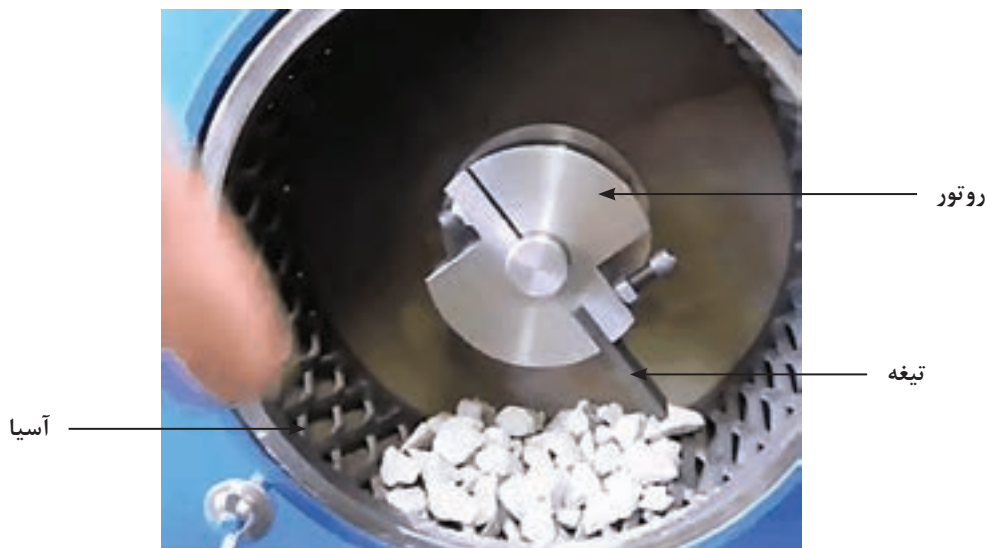
شکل ۳- نمای داخلی آسیای استاندارد ساینده‌گی باند
