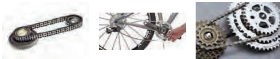
شکل ۲۱- مکانیزم‌های چرخ زنجیری
