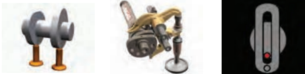
شکل ۲۸- نمونه‌هایی از مکانیزم‌های لنگی و بادامکی
