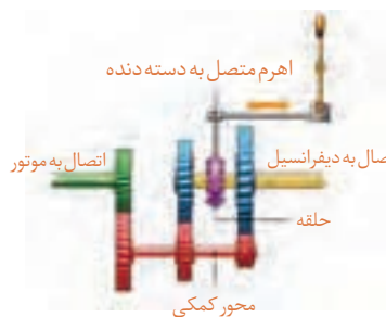
شکل ۱۴- مکانیزم چرخ دنده‌ای
