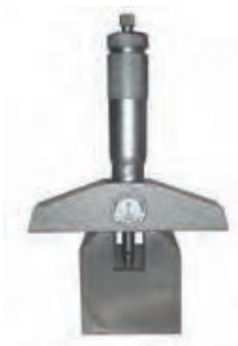
شکل ۵- اندازه گیری با میکرومتر عمق سنج
