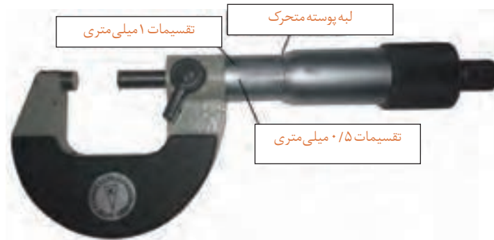
شکل ۲- میکرومتر با استوانه متحرک ۵۰ قسمتی
