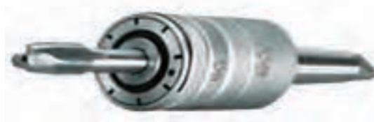
شکل ۵- تجهیزات بستن قلاویز روی ماشین مته ستونی
