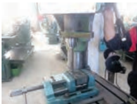
شکل ۱۳- نصب برقو روی محور دستگاه مته
