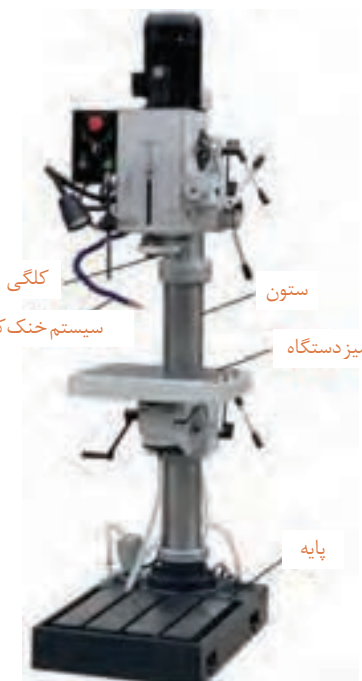
شکل ۳- دستگاه مته ستونی
