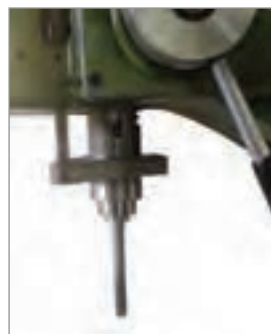
شکل ۱۳- نصب برقو روی محور دستگاه مته
