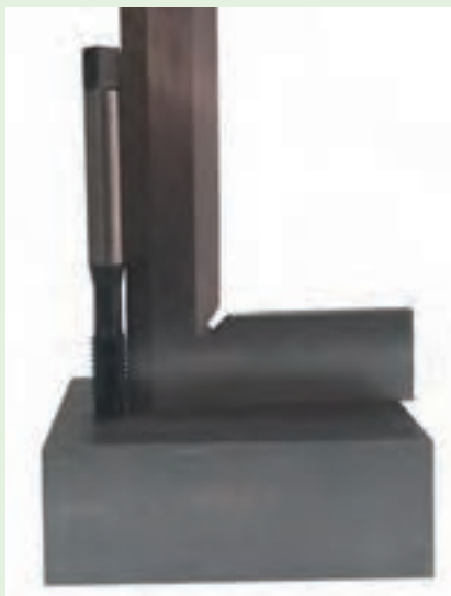
شکل ۷- کنترل عمود بودن قلاویز با سوراخ
