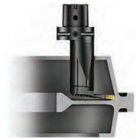
شکل ۶- ایجاد شیار در داخل سوراخ
