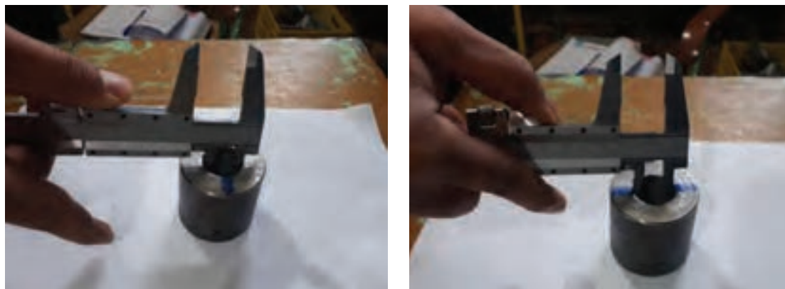
شکل ۲۴- کنترل دایره ای بودن سوراخ
