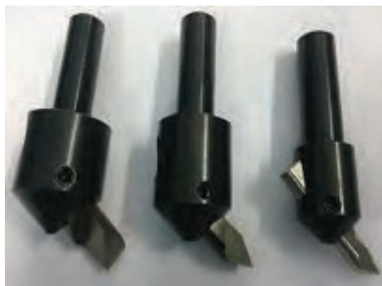
شکل ۱۱- ابزار داخل تراشی
