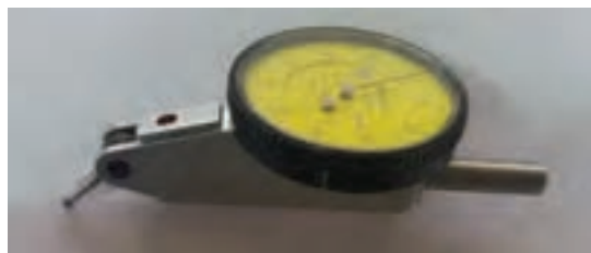
شکل ۲۵- ساعت حساس (شیطانکی) برای کنترل دایره‌ای بودن
