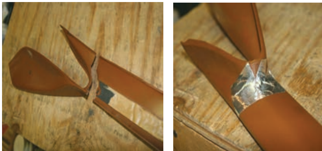
شکل ۲۸- همتراز کردن قطعه به کمک فویل آلومینیومی
