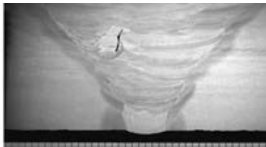
شکل ۳۲- ترک‌های داخلی درون جوش
