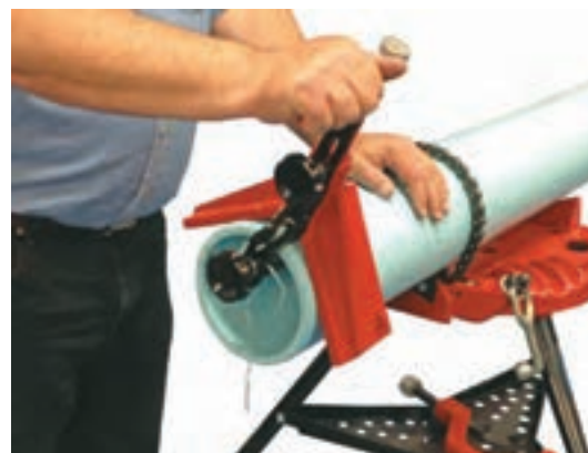
شکل ۲۴- پخ زدن قطعات پلاستیکی برای جوشکاری
