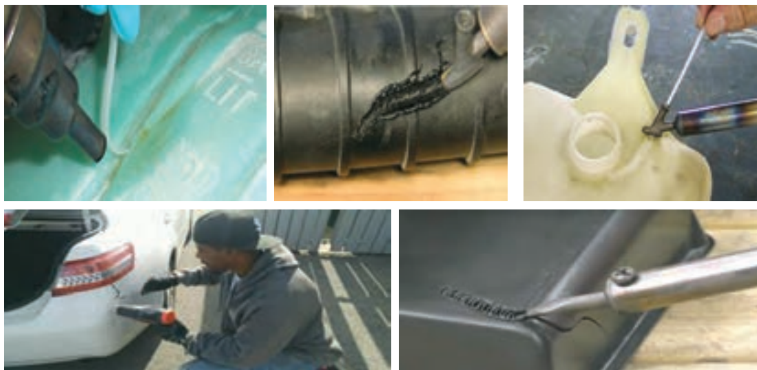
شکل ۲۲- جوشکاری تعمیری قطعات پلاستیکی
