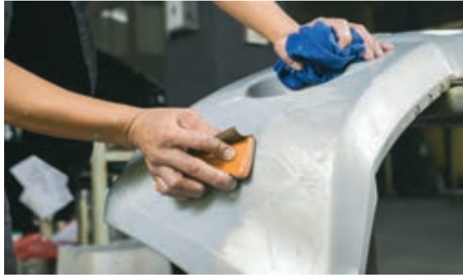
شکل ۳۰- پولیش قطعه کار پس از تعمیر
