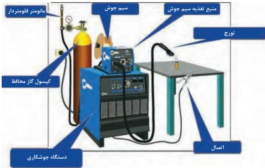
شکل ۶- نمودار تجهیزات مورد استفاده برای جوشکاری نیمه اتوماتیک
