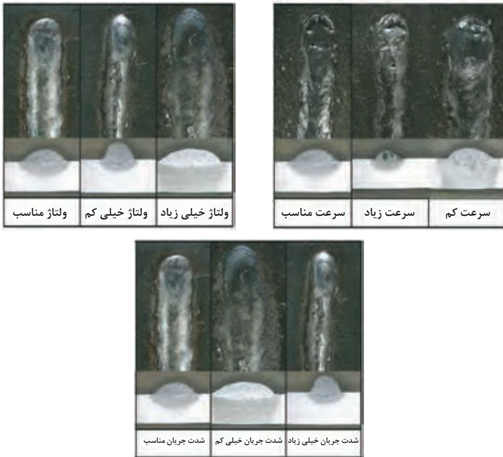
شکل ۱۸- تأثیر سرعت حرکت دست، شدت جریان و ولتاژ بر ظاهر جوش
