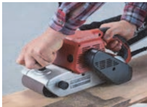
شکل ۴۸- سنباده کاری تخته‌های پهن
