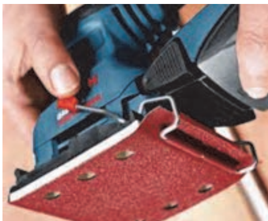
شکل ۴۴- روش جازدن سنباده
