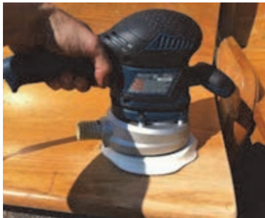
شکل ۴۶- سنباده کاری در جهت الیاف
