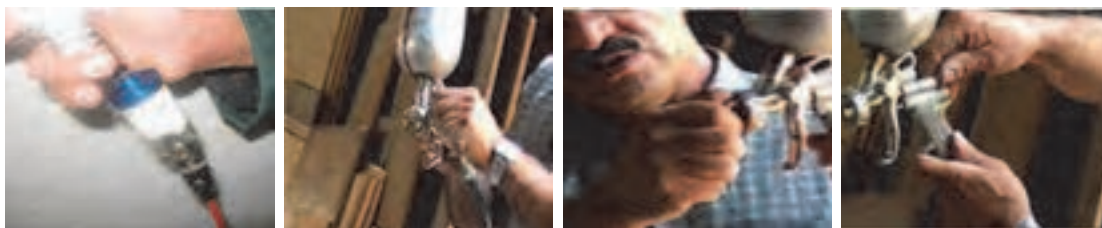
شکل ۱۷۰- پیچ تنظیم مواد شکل ۱۷۱- پیچ تنظیم هوا شکل ۱۷۲- پیچ تنظیم پرده رنگ شکل ۱۷۳- محل اتصال شیلنگ باد
