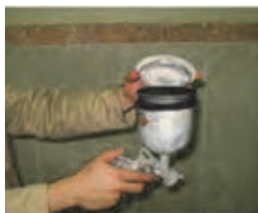
شکل ۱۶۹- مخزن پیستوله
