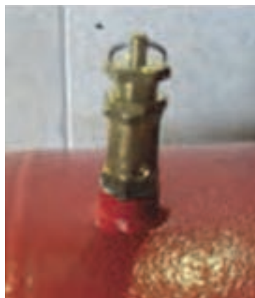
شکل ۱۸۹- سوپاپ کمپرسور برای خروج هوای اضافی
