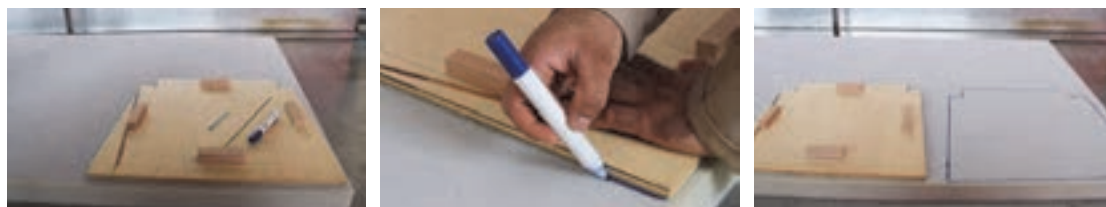
شکل ۳- اندازه‌گیری و خط‌کشی کفی صندلی
