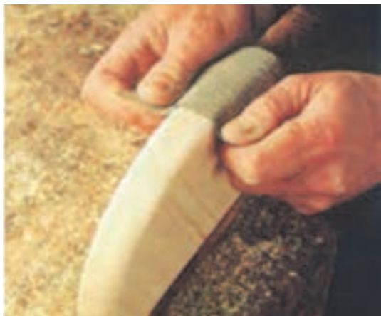
شکل ۱۵- سنباده کاری روی سطوح قوس دار
