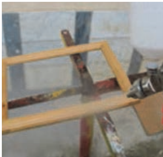
شکل ۴۴- زدن پلی استر با پیستوله
