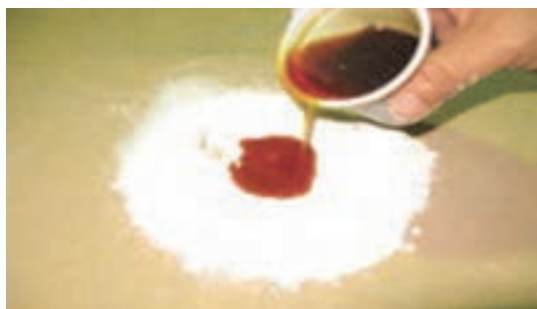
شکل ۸۶- اضافه نمودن رنگ روغنی به بتونه روغنی
