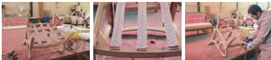
شکل ۳۰- مراحل تسمه کشی
