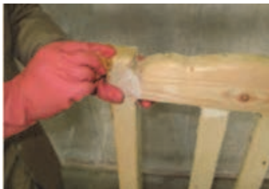
شکل ۷۱- بتونه کاری غیر پوششی
