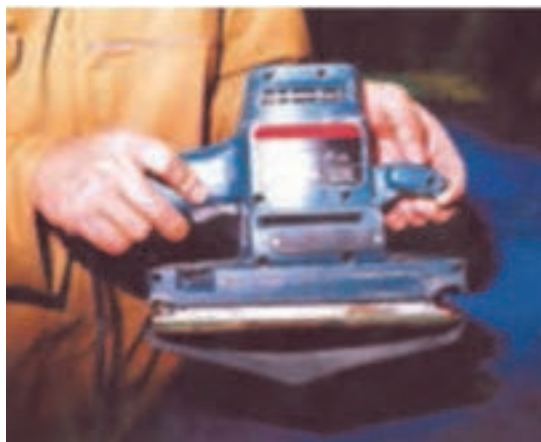
شکل ۴۷- شل شدن کاغذ سنباده
