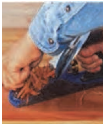
شکل ۱۲۶- رنده کاری سطح چوب
