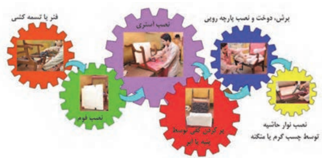
شکل ۲- مراحل اجرای رویه کوبی
