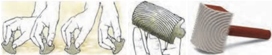
شکل ۱۶۰- روش صحیح استفاده از نقش انداز
