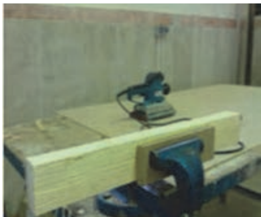
شکل ۴۵- بستن کار به گیره
