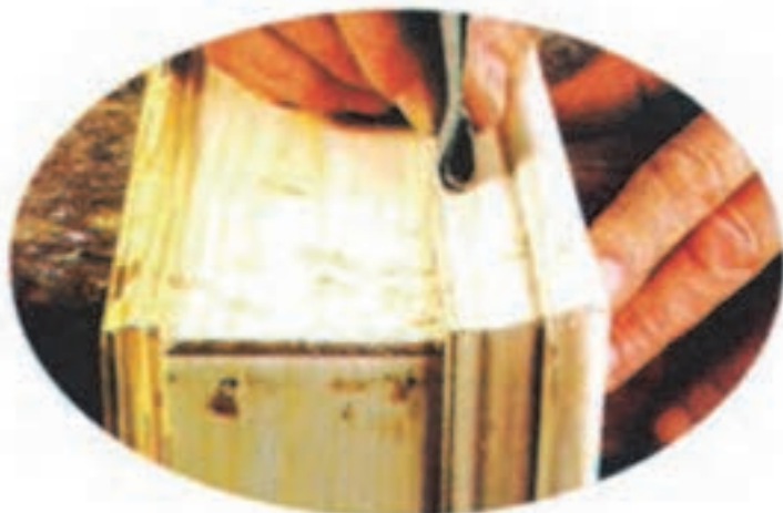
شکل ۱۴- سنباده کاری روی سطوح محدب و مقعر
