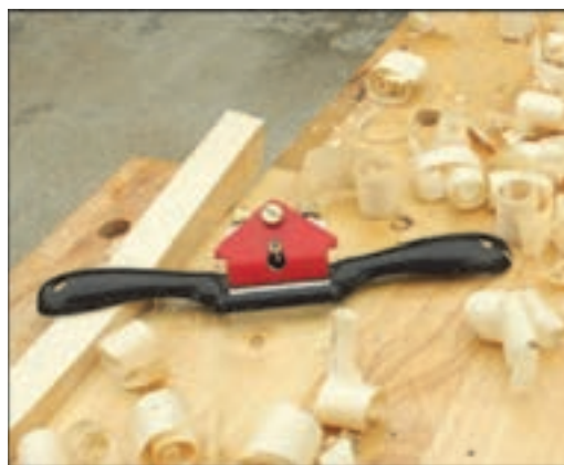
شکل ۵۸- نصب لیسه به رنده بال کبوتری
