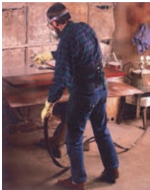
شکل ۴۶- ب) پاشیدن پلی استر ایستاده به سطح کار
