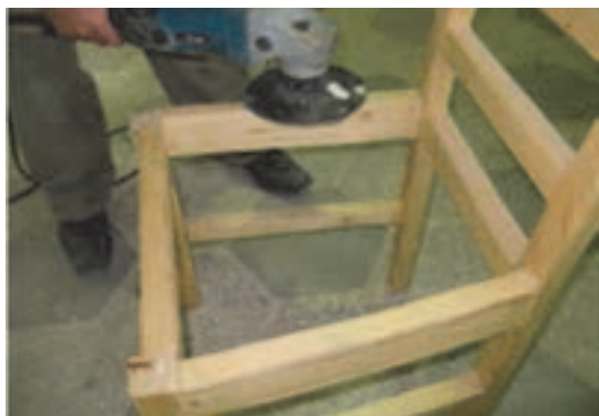
شکل ۷۲- پرداخت کاری قبل از بتونه
