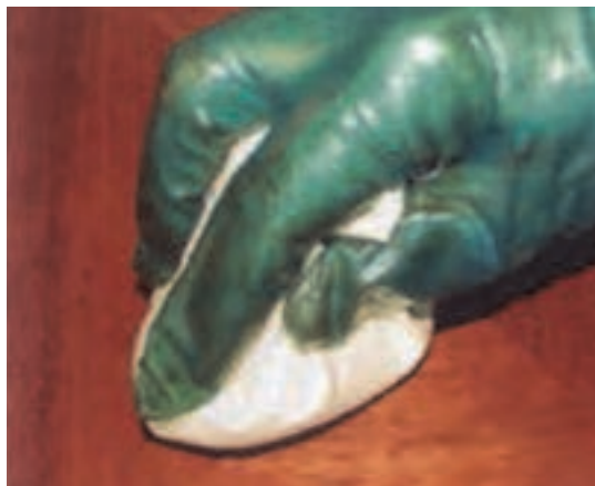
شکل ۱۴۵- استفاده از پارچه در لاک و الکل کاری
