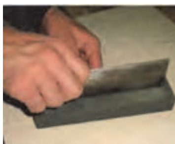
شکل ۱۱۸- سوهان کشیدن روی نر لیسه شکل ۱۱۹- کشیدن لیسه روی سنگ نفت شکل ۱۲۰- کشیدن لبه لیسه به سنباده
