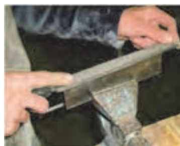
شکل ۱۱۸- سوهان کشیدن روی نر لیسه شکل ۱۱۹- کشیدن لیسه روی سنگ نفت شکل ۱۲۰- کشیدن لبه لیسه به سنباده
