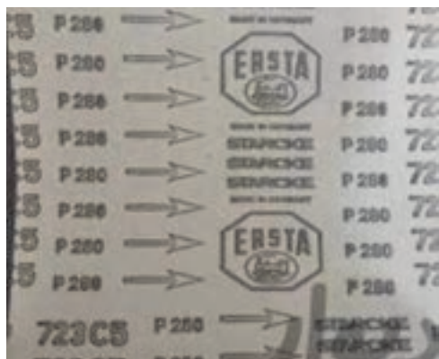
شکل ۵۱- به جهت فلش ورق سنباده توجه کنید.
