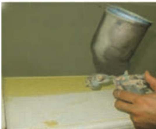
شکل ۳۰- پاشیدن رنگ نیترو سلولزی با پیستوله
