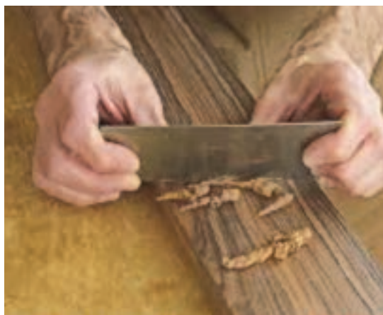
شکل ۵۵- لیسه کشی در جهت الیاف
