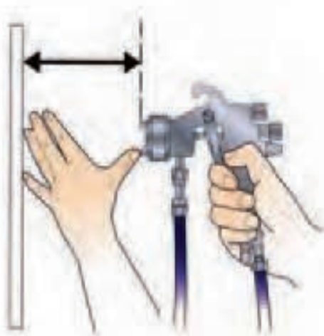
شکل ۴۶- الف) رعایت فاصله پیستوله با سطح کار
