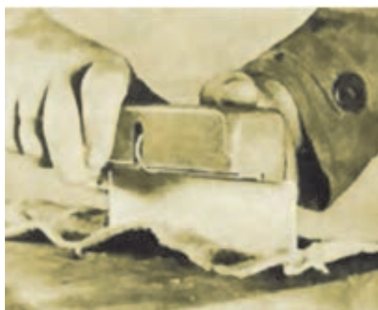
شکل ۶۲- مصقل کشی در لیسه با رنده مصقل
