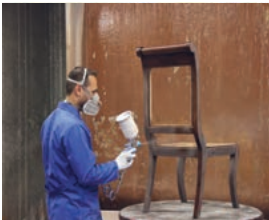
شکل ۱۹- پاشیدن رنگ با پیستوله
