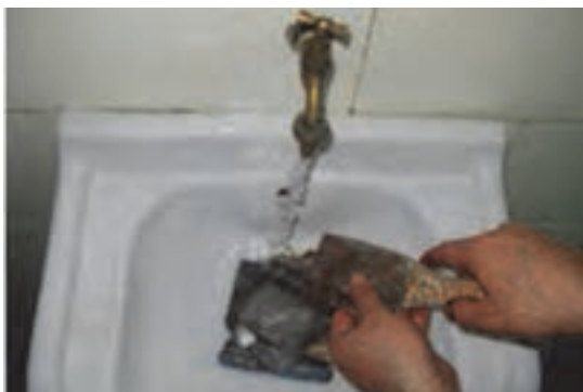
شکل ۱۴۰- شستن و تمیز کردن لیسه و کاردک
