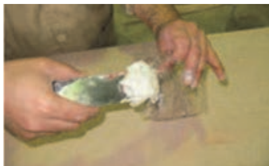
شکل ۶۸- قرار دادن بتونه سریش داخل پلاستیک
