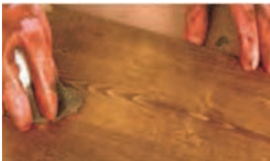
شکل ۱۴۴- زدن آستری هم رنگی با پارچه
