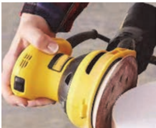
شکل ۳۳- فشار یکنواخت به سطح کار
