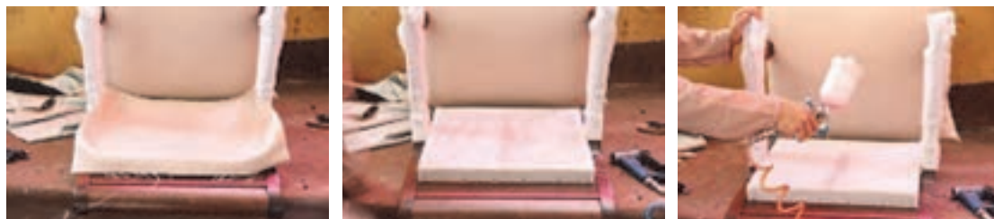
شکل ۳۸- مراحل رویه کوبی پشتی مبلمان
