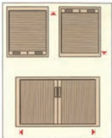
شکل ۸- درهای کرکره‌ای عمودی و افقی
