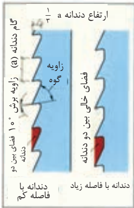
شکل ۱- تیغ اره نواری مناسب برش های طولی
