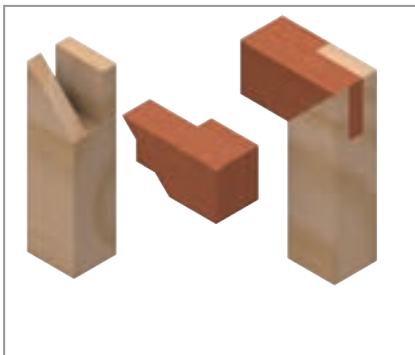
۴- اتصال گوشه‌ای فاق و زبانه یک رو فارسی.
