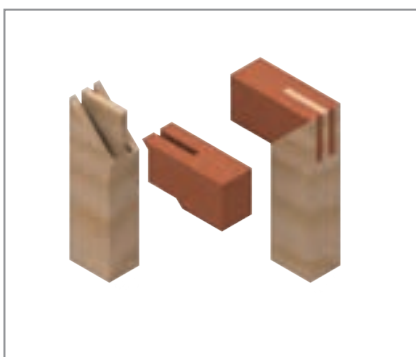
شکل ۸- اتصال گوشه‌ای فاق و زبانه دو تایی دو رو فارسی.
