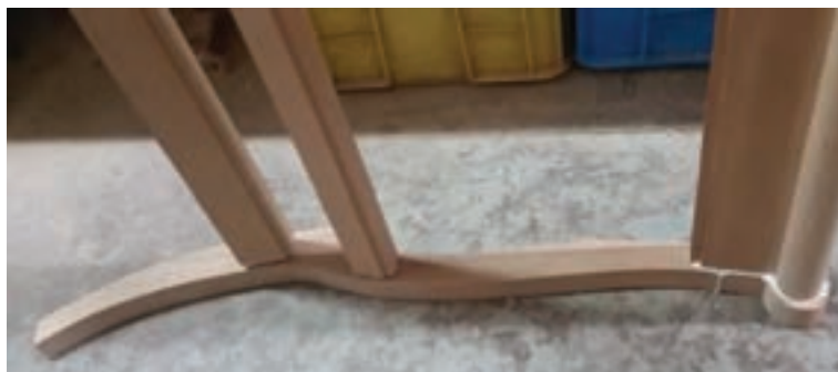
شکل ۴۸- جا زدن پشتی مبل
