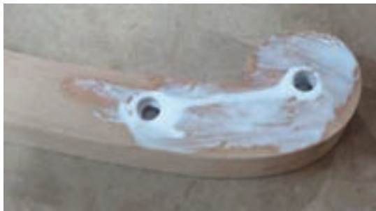
شکل ۴۶- روش چسب زدن اتصال دوبل پایه‌های عقب
