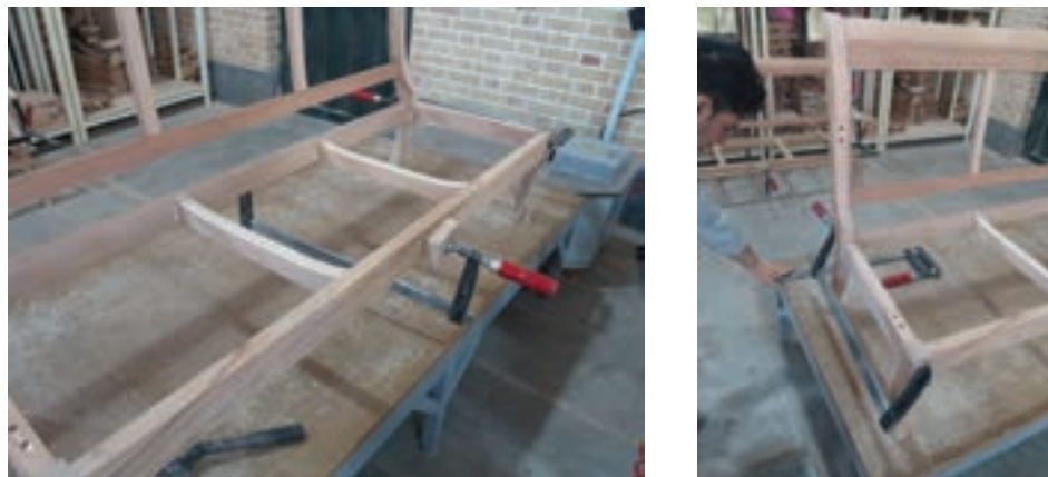
شکل ۵۶- جا زدن اتصالات با گیره دستی
