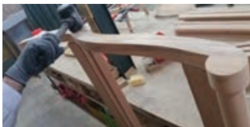
شکل ۴۹- استفاده از چکش پلاستیکی برای جا زدن قطعات
