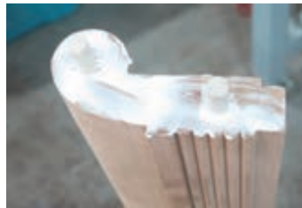
شکل ۴۶- روش چسب زدن اتصال دوبل پایه‌های عقب
