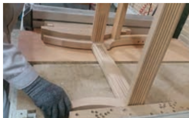
شکل ۵۵- جا زدن اتصالات با تنگ پنوماتیکی
