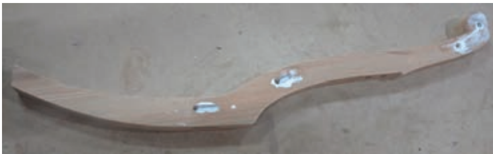
شکل ۴۶- روش چسب زدن اتصال دوبل پایه‌های عقب
