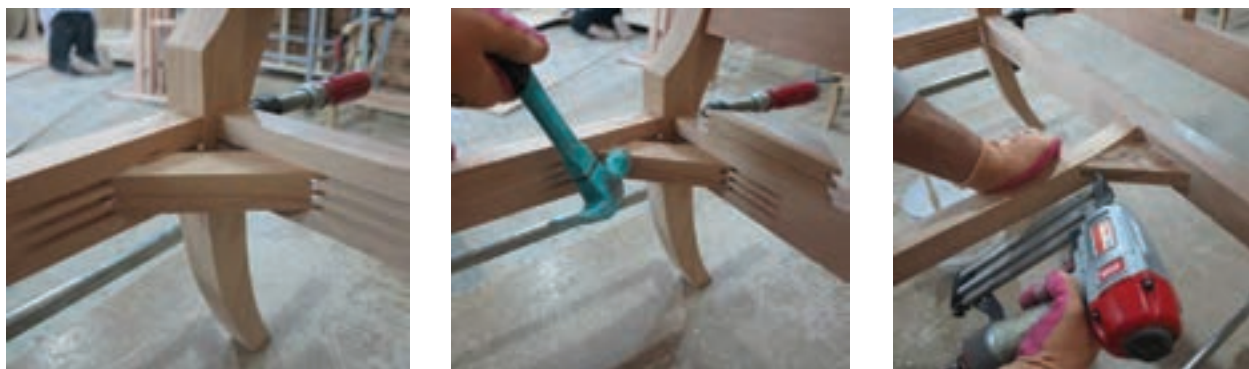
شکل ۵۸- جا زدن نبشی‌های گوشه
