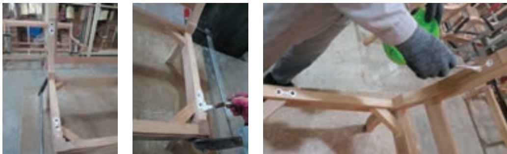
شکل ۵۹- چسب زدن محل اتصالات دسته مبل
