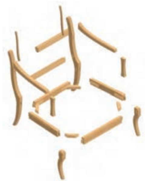
شکل ۴۳- قطعات آماده مونتاژ مبل
