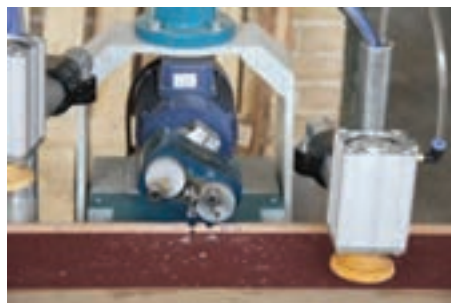
شکل ۳۸- ایجاد اتصال با دستگاه دابل زن نیمه اتوماتیک
