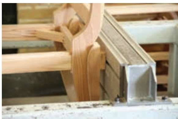
شکل ۵۵- جا زدن اتصالات با تنگ پنوماتیکی
