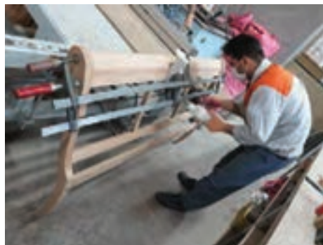
شکل ۵۲- تمیز کردن چسب اضافی روی قطعه کار
