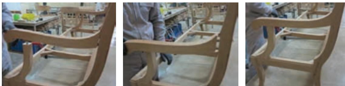
شکل ۶۱- کنترل صحیح بودن دسته مبل
