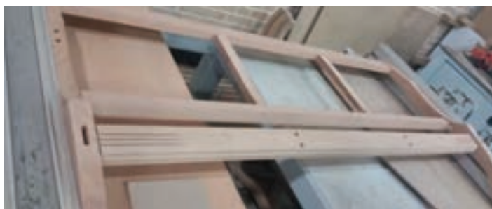
شکل ۵۰- جا زدن پشتی مبل با تنگ پنوماتیک
