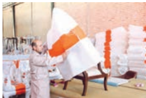
شکل ۶۳- مراحل مختلف بسته‌بندی و آماده کردن مبل یک نفره به منظور ارسال به مشتری
