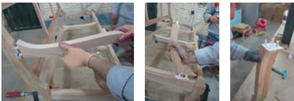
شکل ۶۰- جا زدن دسته مبل در محل اتصالات
