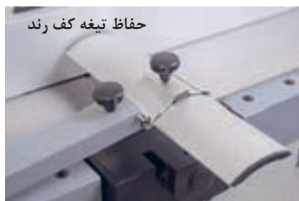
شکل ۳- نمونه هایی از حفاظ های مخصوص تیغه هر دستگاه
