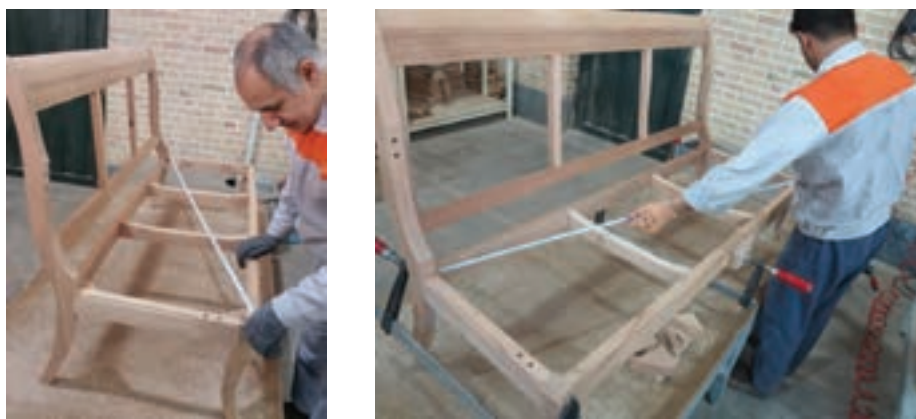
شکل ۵۷- کنترل دوئیدگی (گونمایی کردن کار) با متر
