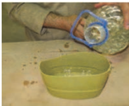
شکل ۳۱- استفاده از تینر فوری برای رقیق کردن سیلر
