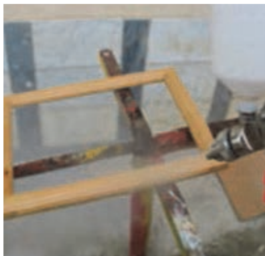
شکل ۴۴- زدن پلی استر با پیستوله
