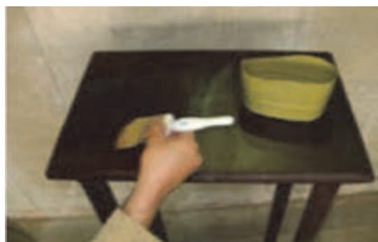
۳۲- زدن سیلر با قلم مو روی سطح آستر خورده
