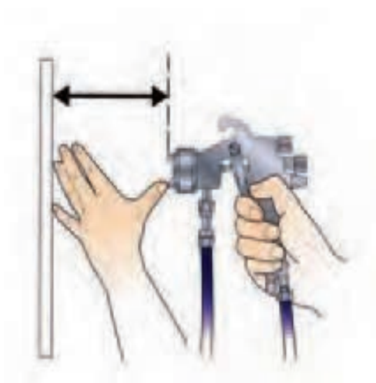
شکل ۴۶- الف) رعایت فاصله پیستوله با سطح کار
