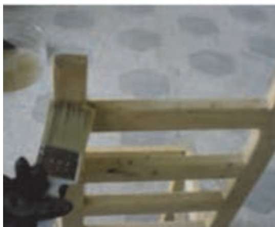
شکل ۴۰- زدن کیلر به صندلی با قلم مو
