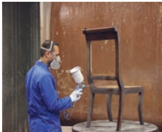
شکل ۱۹- پاشیدن رنگ با پیستوله
