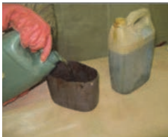
شکل ۴- رقیق کردن روغن الیف با تینر روغنی
