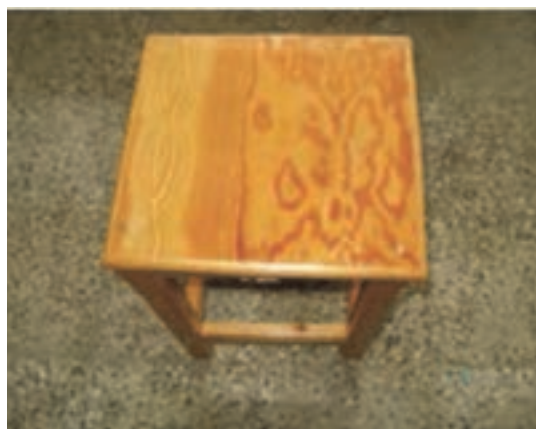
شکل ۲۷- اثر بتونه روی صفحه چهارپایه کاملاً نمایان است.
