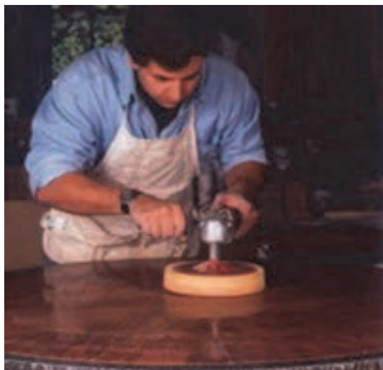
شکل ۴۸- پولیش کاری سطح پلی‌استر خورده
