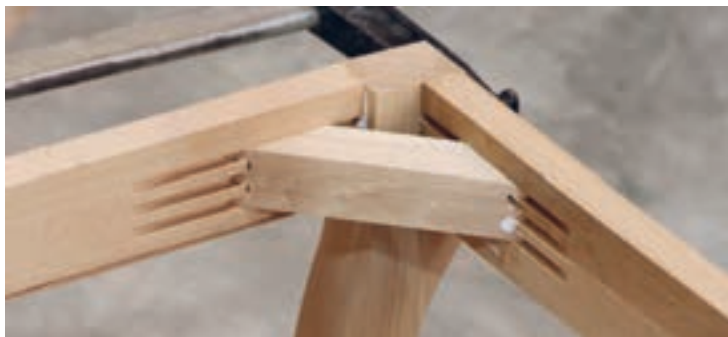
شکل ۱۲- اتصال انگشتی نبشی (بلوک سه‌گوش)
