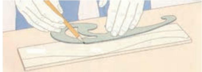
شکل ۴۲- آماده کردن الگوی پایه به وسیله پیستوله
