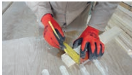
شکل ۵۲- اندازه‌گذاری به وسیله گونیا
