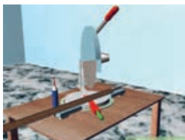
شکل ۷۳- اندازه‌گیری و برش زهوار دور میز عسلی
