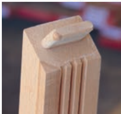
شکل ۵۹- اتصال کام تحت زاویه ۴۵ درجه
