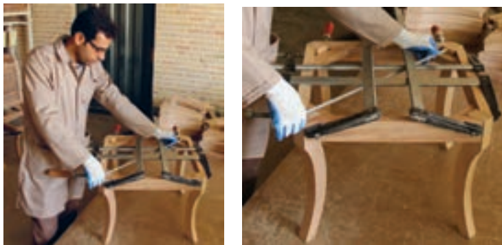
شکل ۶۹- کنترل دوئیدگی با متر
