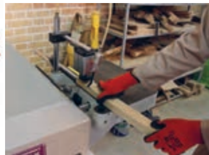
شکل ۵۴- کام کندن چوب با دستگاه کام کن نیمه اتوماتیک
