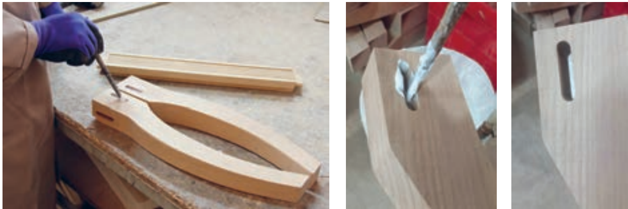
شکل ۶۴- چسب زدن کام پایه‌ها
