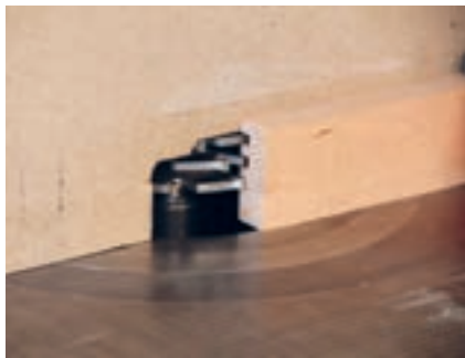
شکل ۶۱- تیغ فرز مخصوص زهوار صفحه
