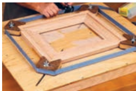
شکل ۷۲- گیره مخصوص بستن قاب
