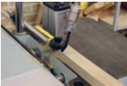
شکل ۵۵- دستگاه کام کن نیمه اتوماتیک
