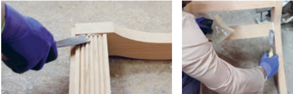
شکل ۶۷- تمیز کردن چسب اضافی با کاردک
