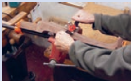
شکل ۵۰- عمل پرداخت کاری با چوبساز، رنده بال کبوتری و سوهان
