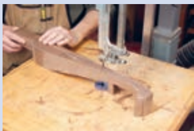
شکل ۴۹- قوس بری چوب: مرحله دوم
