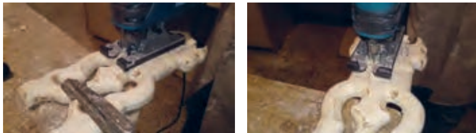
شکل ۶۸- برش طولی مفصل با اره عمودبر
