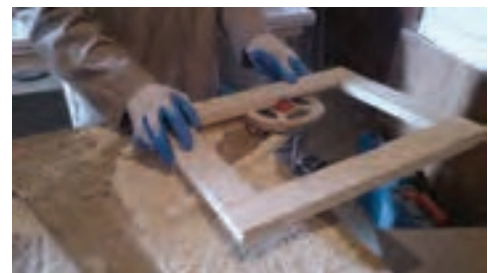
شکل ۴۰- پرداخت با تیغ نیم‌گرد و به کمک دستگاه اورفرز دستی
