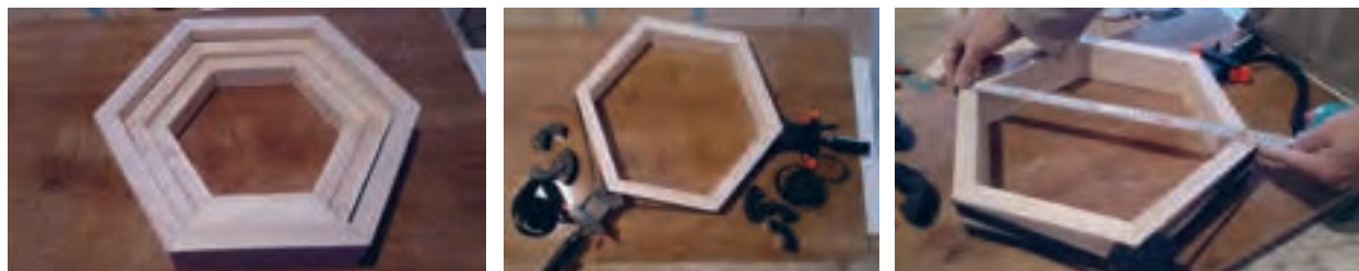
شکل ۵۲- کنترل دوئیدگی و صحیح بودن قاب‌های شش ضلعی‌ها
