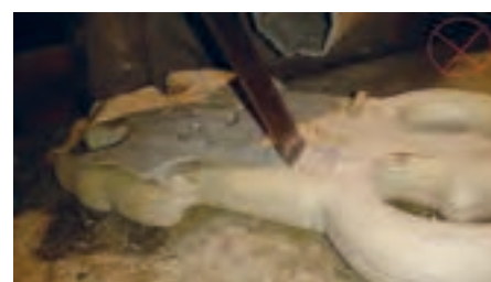
شکل ۶۶- مغار کاری به روش صحیح، به جهت پخ مغار توجه کنید
