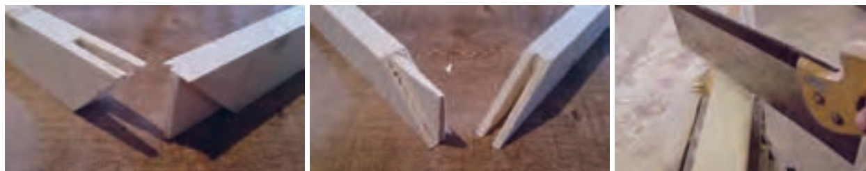
شکل ۳۴- برشکاری اتصال دو رو فارسی
