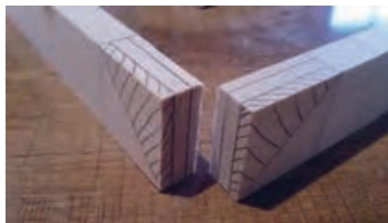
شکل ۳۲- چگونگی خط‌کشی و مونتاژ اتصال یک رو فارسی
