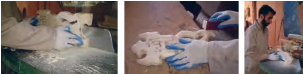
شکل ۶۷- برش میانی رحل چوبی با دستگاه اره نواری
