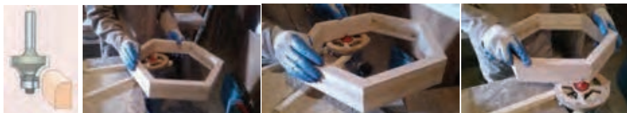
شکل ۵۳- پرداخت با تیغ نیم‌گرد به وسیله دستگاه اورفرز دستی
