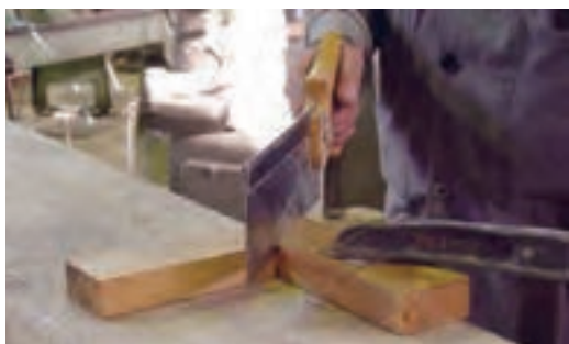
شکل ۳۵ - چگونگی اهر کشی درز بین اتصال
