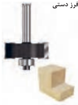
شکل ۴۱- دو راهه کردن با دستگاه اورفرز دستی و تیغ دو راهه
