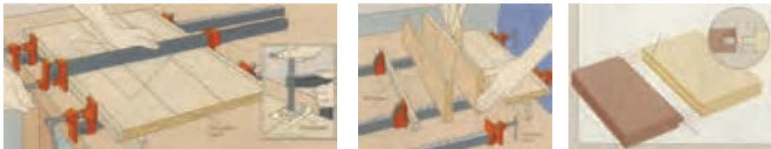
شکل ۴۳- نحوه درز کردن اتصالات عرضی
