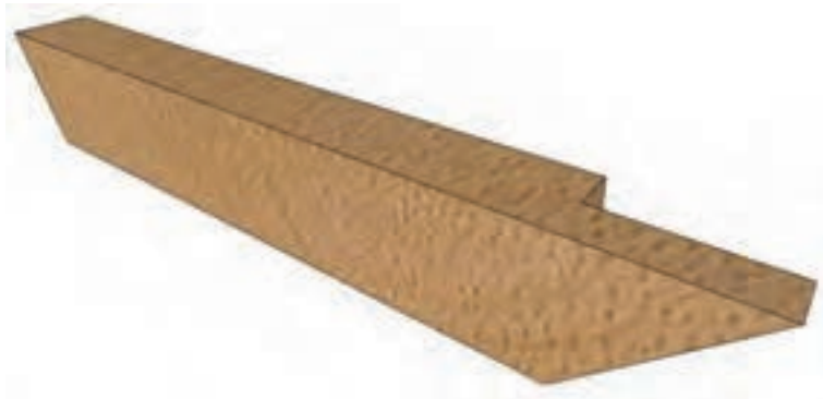
شکل ۲۴ - اتصال نیم و نیم فارسی
