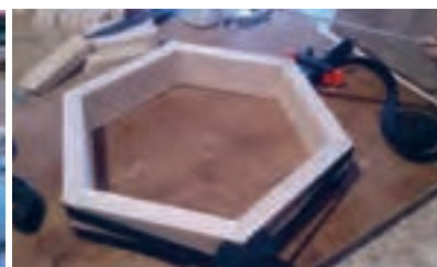
شکل ۵۱- جا زدن قیدها و بستن با گیره تسمه‌ای
