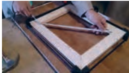
شکل ۳۹- کنترل دوئیدگی و صحیح بودن قاب
