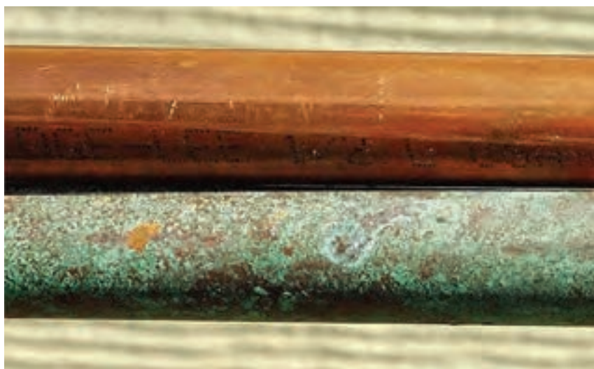
شکل ۳۳- تغییر رنگ لوله مسی در مجاورت هوای مرطوب
