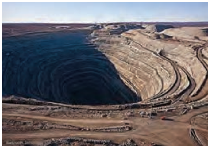
شکل ۲۷- چاله‌های پلکانی در یک معدن روباز
