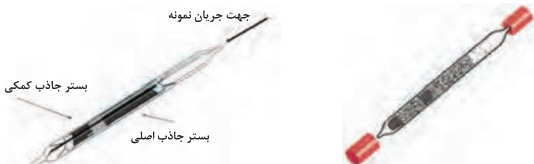
شکل ۲۰- لوله جذب سطحی حاوی زغال فعال
