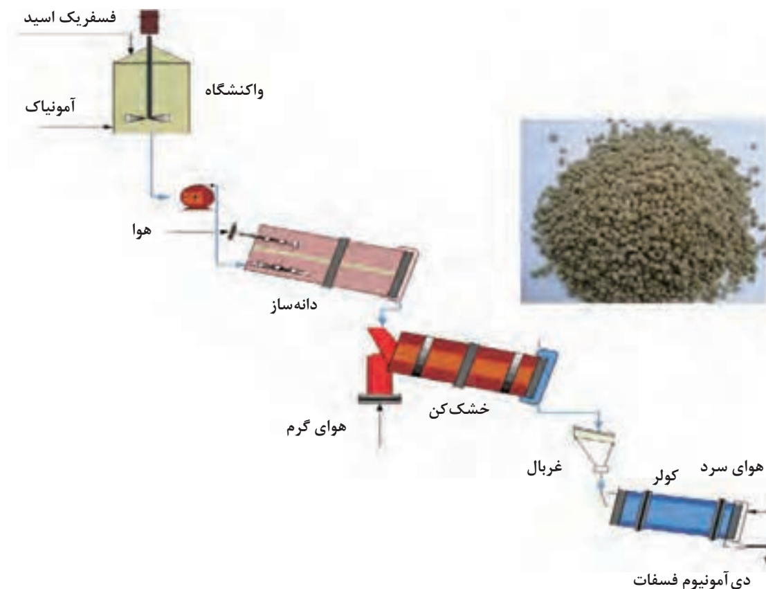
شکل ۹- فرایند تولید دی آمونیوم فسفات
