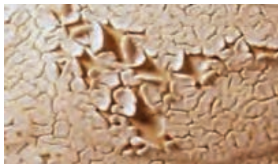
شکل ۴۲- پوسته شدن و ترک خوردگی در لعاب
