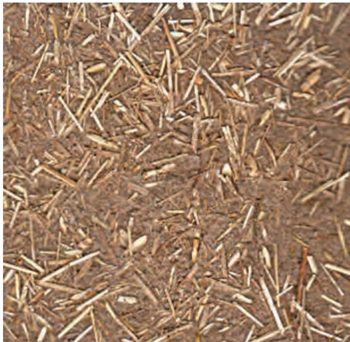
شکل ۳۱ - کاه گل یک نوع کامپوزیت طبیعی
