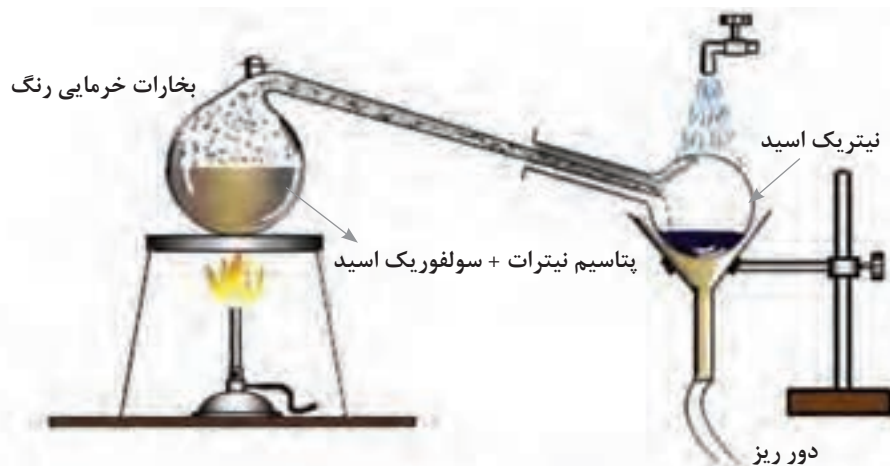
شکل ۷- سامانه تهیه نیتریک اسید
