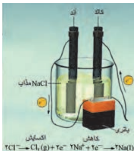
شکل ۱۵- برقکافت سدیم کلرید مذاب: الف) روش آزمایشگاهی، ب) فرایند صنعتی
