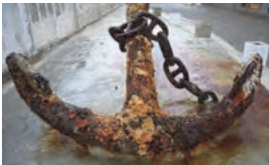
شکل ۳- نمونه‌هایی از خوردگی آب دریا
