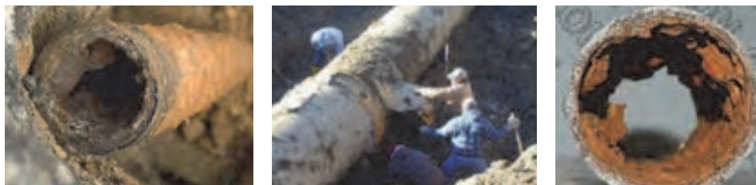
شکل ۴- نمونه‌ای از خوردگی لوله‌های دفن شده
