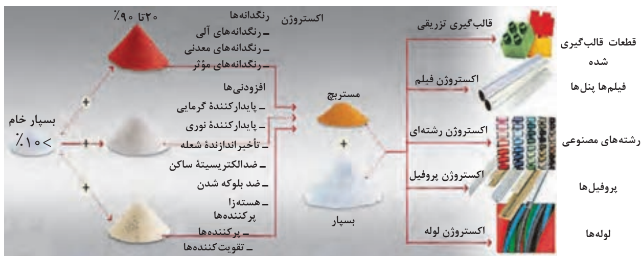
شکل ۶- فرایند تولید مستربچ و قطعات بسپاری
