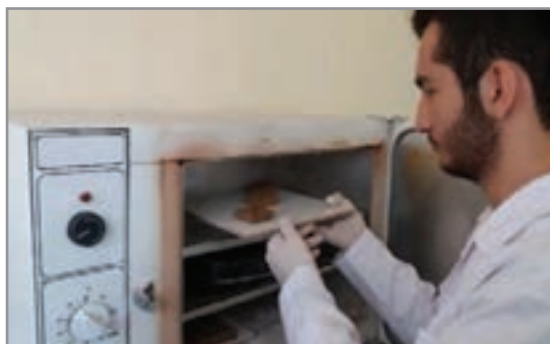
شکل ۹- انتقال نمونه‌های انقباض به خشک‌کن و تنظیم دما
