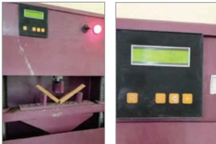
شکل ۲۴- اندازه‌گیری استحکام خمشی خشک نمونه‌ها
