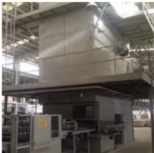
شکل ۱۸- خشک کن عمودی سریع
