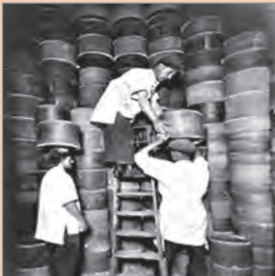
شکل ۶۷ - چیدمان ستونی ساگارها در کوره‌های سنتی
