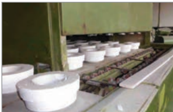
الف) قرارگیری قالب جولی در خشک‌کن حلقوی
