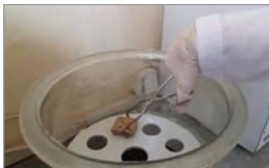
شکل ۱۰- انتقال نمونه‌های انقباض از خشک‌کن به دسیکاتور
