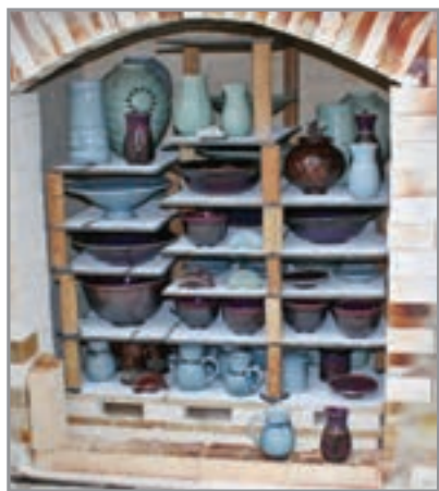
الف) قفسه بندی برای پخت قطعات بیسکویت ب) قفسه بندی برای پخت قطعات لعاب خورده
