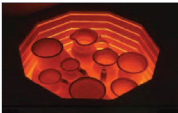
شکل ۲- بدنه‌های سرامیکی در حال پخت
