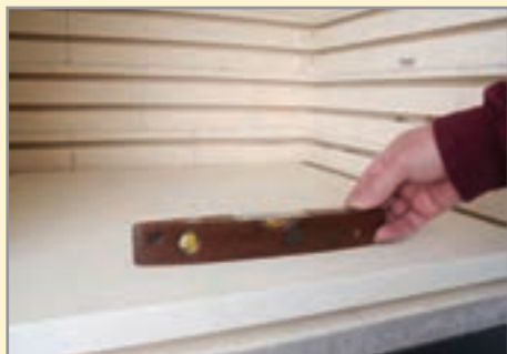
شکل ۲۸- بررسی تراز بودن کف کوره کارگاهی
