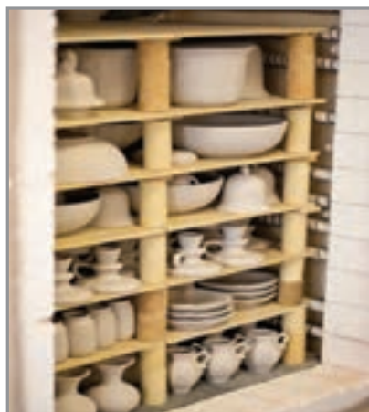
الف) قفسه بندی برای پخت قطعات بیسکویت ب) قفسه بندی برای پخت قطعات لعاب خورده
