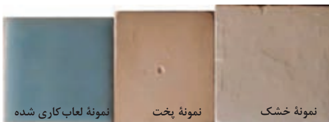
شکل ۱۲- تأثیر انقباض پخت بر ابعاد نمونه
