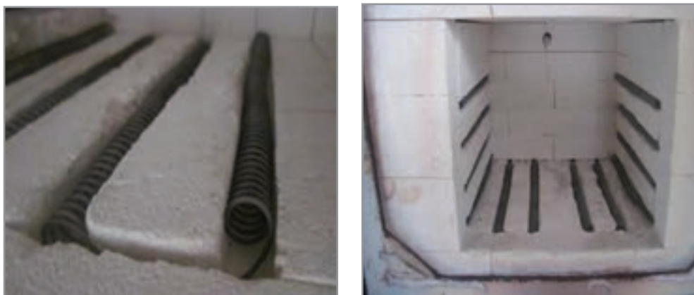
شکل ۱۳- نصب المنت درون شیار
