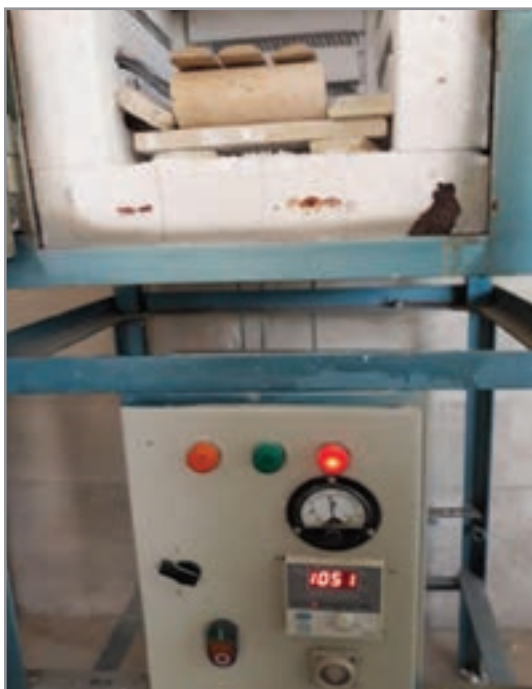
شکل ۳۵- تنظیم دمای کوره حاوی نمونه‌های مقاومت به پخت
