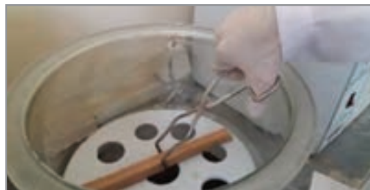
شکل ۲۳- انتقال نمونه‌های استحکام خمشی خشک از خشک‌کن به دسیکاتور
