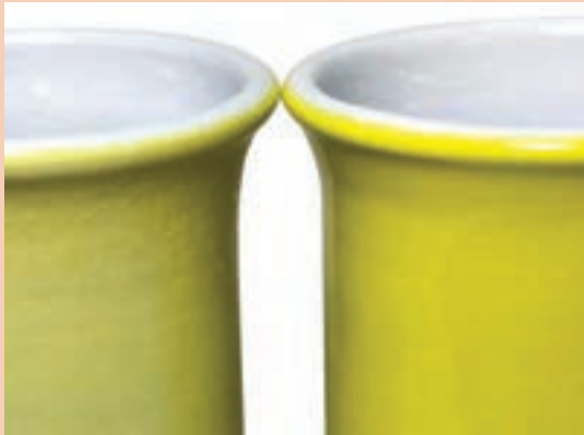
الف) لعاب با سطح صاف ب) لعاب پوست پرتقالی
