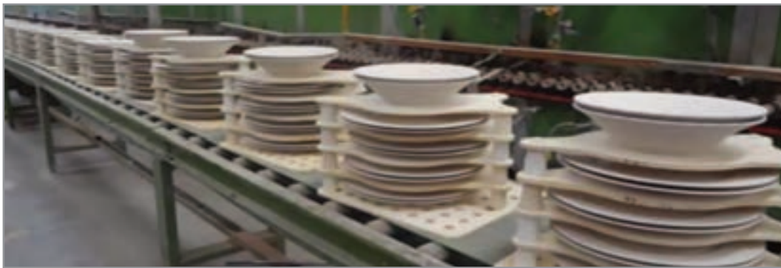
شکل ۴۲- استفاده از سترها برای پخت ظروف
