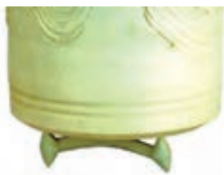
شکل ۵۶- قرار گرفتن قطعه بر روی سه پایه
