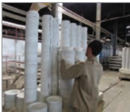
شکل ۴۹- استفاده از ساگار برای چیدمان
