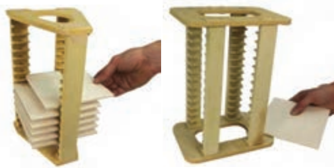
شکل ۵۱ - چیدمان کاشی در چنگک
