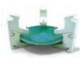
شکل ۵۴- مونتاژ چنگک پین دار برای پخت بشقاب لعاب خورده
