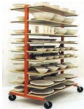
الف) قفسه چرخ دار با صفحات چوبی برای انتقال و خشک کردن قطعات
