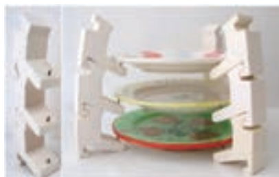
شکل ۵۴- مونتاژ چنگک پین دار برای پخت بشقاب لعاب خورده
