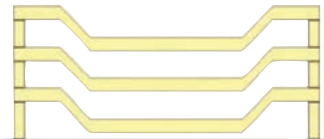
شکل ۴۶ - حفظ فاصله بین سطح زیرین اولین ستر و کف
