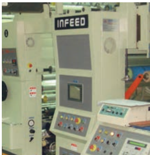
شکل ۴۴- واحد کنترل مجموعه غلتک‌های تنظیم کشش
