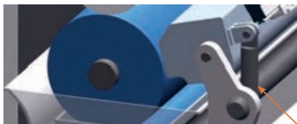
شکل ۸۶- جک تنظیم فشار داکتر بلید
