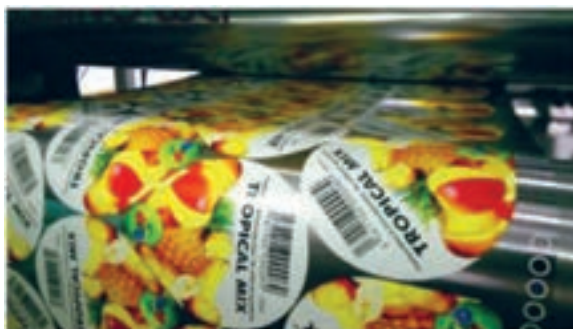
شکل ۹- چاپ از رو بر روی فویل آلومینیوم
