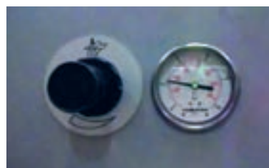
شکل ۵۴- دستگیره تنظیم فشار و گیج آن
