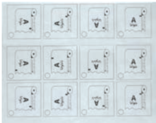
شکل ۲۱- حالت‌های مختلف پیچش رول
