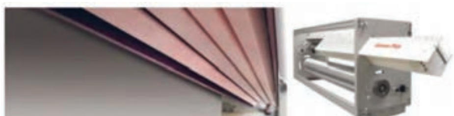
شکل ۱- دستگاه کرونا کردن سطح چاپ شونده
