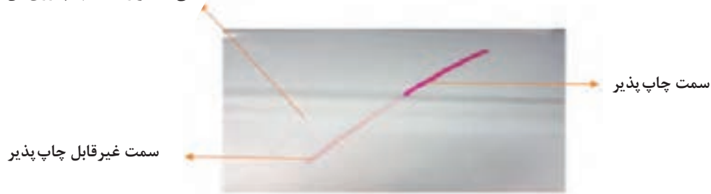
شکل ۲۲- نتیجه تست کرونا تریتمنت
