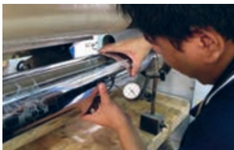
شکل ۴۶- بالانس سیلندر
