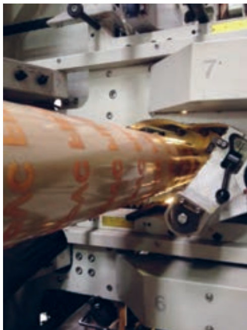
شکل ۳۵- جاگذاری سیلندر کلیشه بر روی آداپتور
