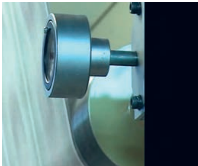
شکل ۴۶- غلتک تنظیم (Adjust roll)
