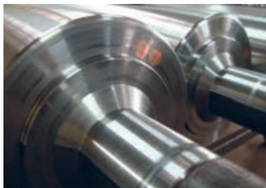
شکل ۲۲- سیلندر آبلزکاری شده
