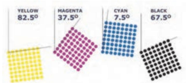
شکل ۳- شمایی از زوایای ترام
