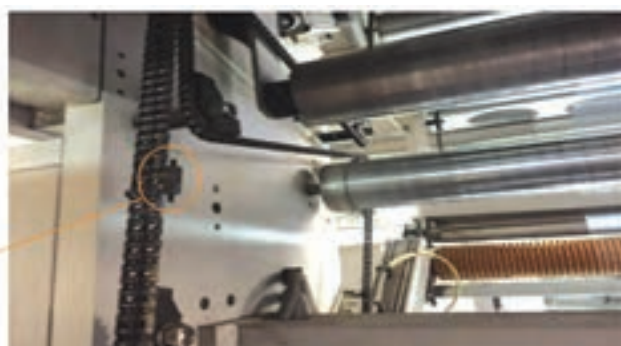
شکل ۵۶- زنجیر مخصوص عبور سطح چاپی
