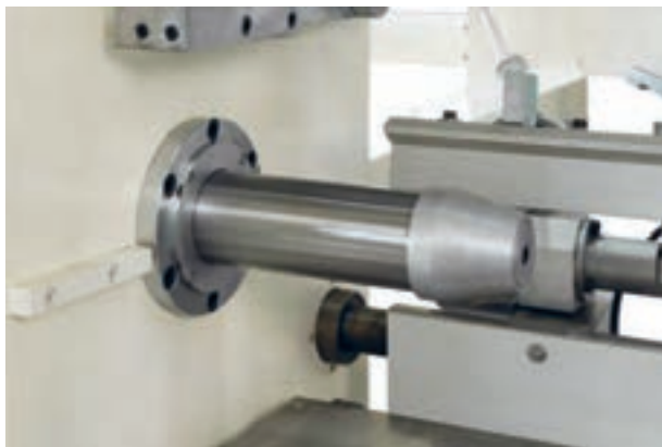
شکل ۴۵- شفت نگهدارنده سیلندر
