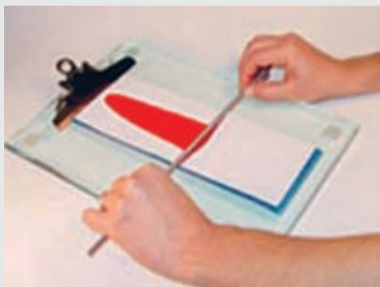
شکل ۲۹- روش کشیدن مرکب با ابزار بارکش
