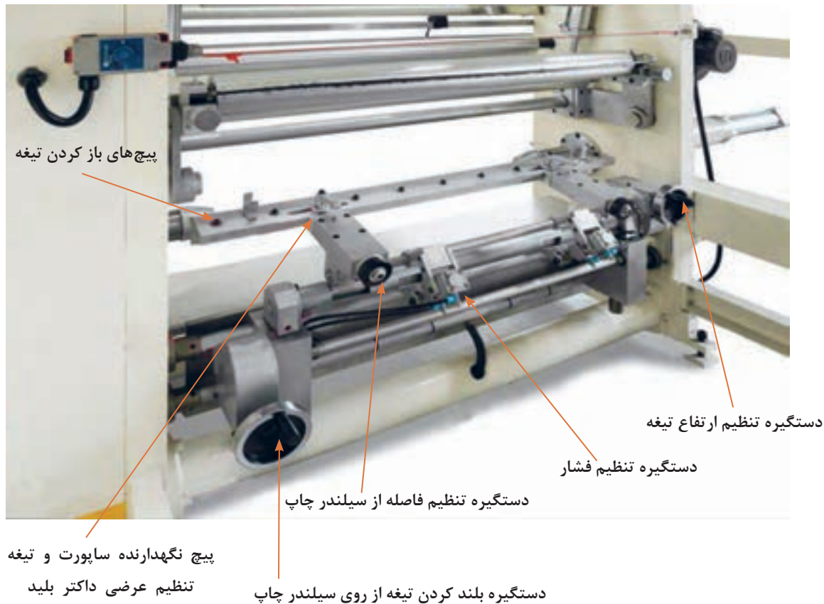
شکل ۸۲- اجزای سیستم داکتر بلید در واحد چاپ
