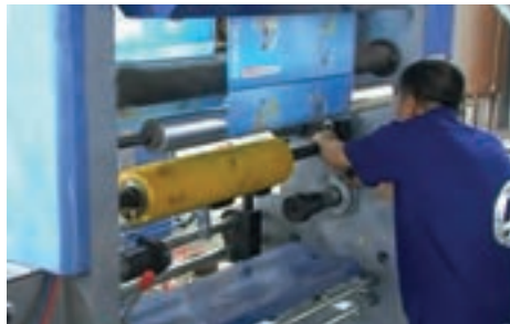
شکل ۶۴- نصب پرس رول سمت اپراتور
