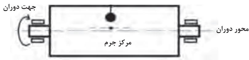
شکل ۵۰- شماتیک بالانس استاتیک
