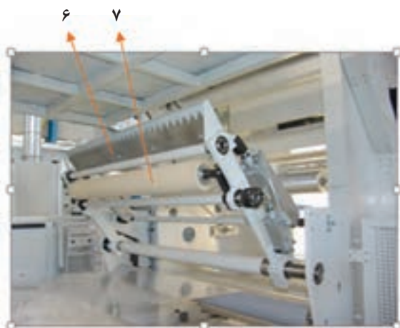
شکل ۳۱- تیغه پیوند یا (Splicer)
