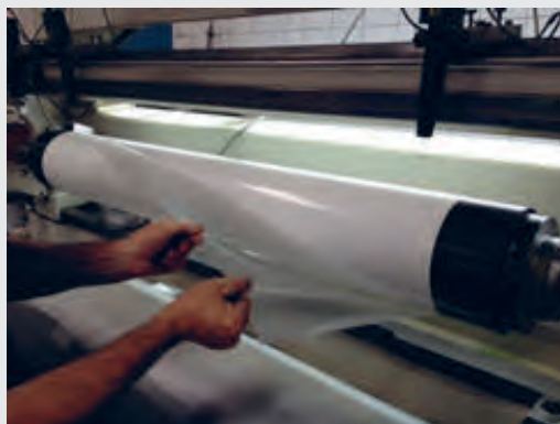
شکل ۱۹- برداشتن لایه محافظ روی چسب
