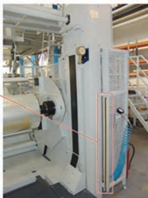
شکل ۳۲- واحد تحویل دستگاه فلکسو
