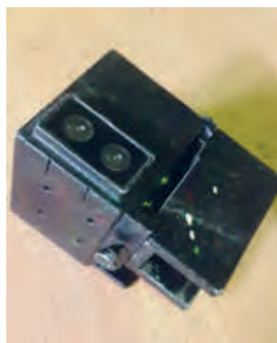
شکل ۱۷- حسگر رجیستری اتوماتیک
