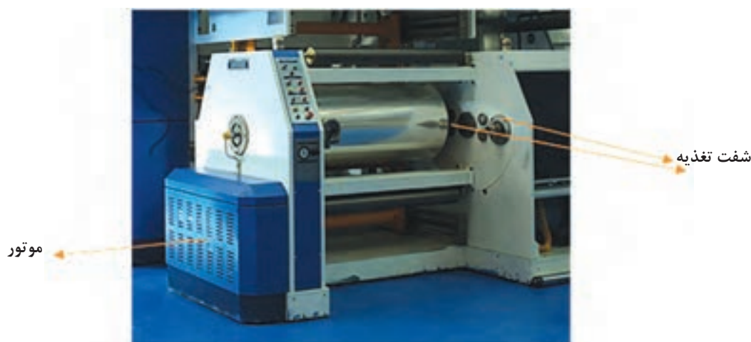
شکل ۴۳- موتور شفت تغذیه
