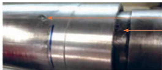
شکل ۱۴- قرار دادن آداپتور روی شفت کلیشه چسبانی
