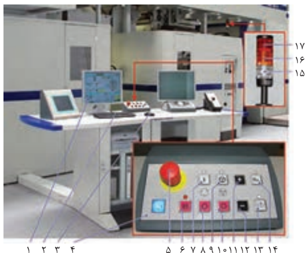
شکل ۶۳- مهم ترین اجزای میز کنترل ماشین
