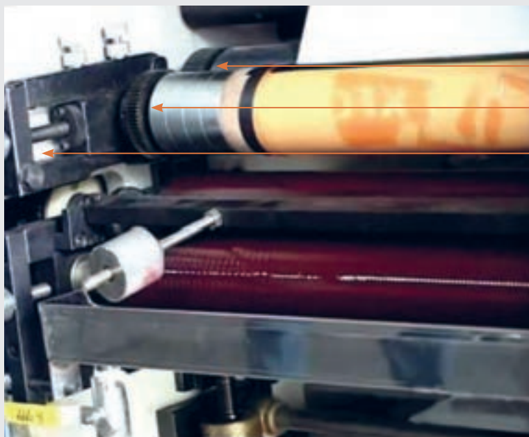
شکل ۳۰- چرخ دنده‌های دستگاه چاپ سیلندر مرکزی
