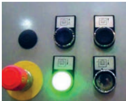
شکل ۵۶- کلیدهای فشار پرس رول
