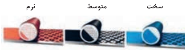
شکل ۱۱- شماتیک فشردگی ذرات فوم چسب پایه
