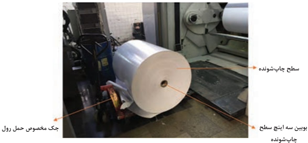
شکل ۳۳- انتقال سطح چاپ شونده به واحد تغذیه
