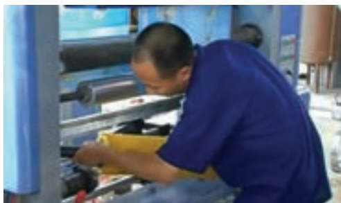
شکل ۶۵- نصب پرس رول سمت موتور
