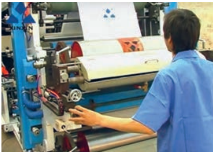
شکل ۲- تنظیم فشار پلایت و سیلندر چاپ
