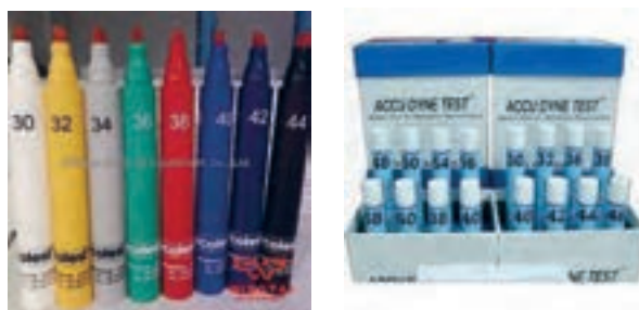
شکل ۲۰- انواع مختلف ماژیک‌های تست کرونا
