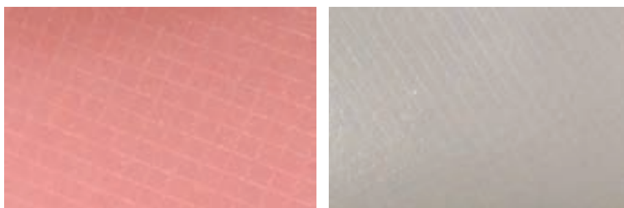
شکل ۱۲- شیارهای موجود بر روی چسب پایه
