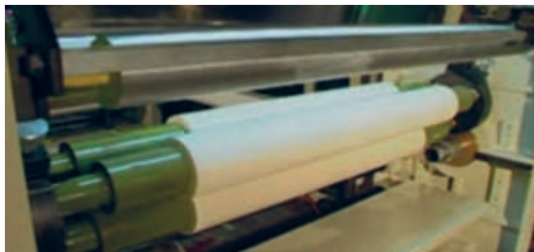
شکل ۱۶- نمونه ای از پرس رول
