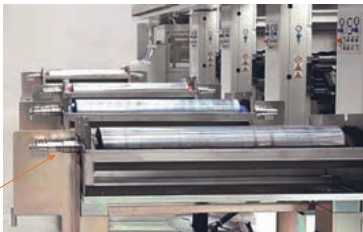
شکل ۴۴- واگن سیلندر جهت نصب در ماشین چاپ
