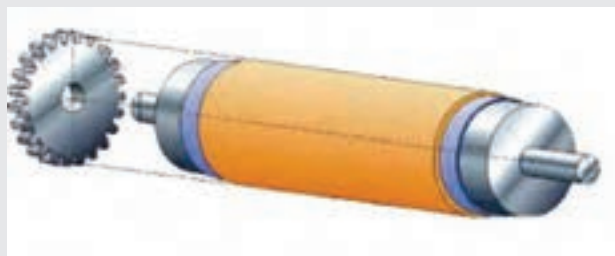
شکل ۲۹- سیلندر کلیشه و چرخ دنده متناسب آن
