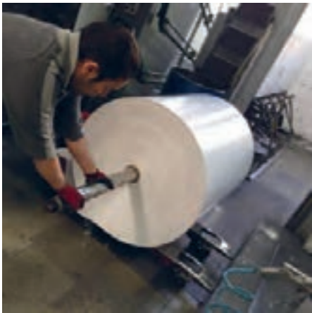
شکل ۳۴- قرار دادن شفت بادی درون بوبین دستگاه
