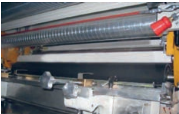
شکل ۵۳- سیستم الکترواستاتیک
