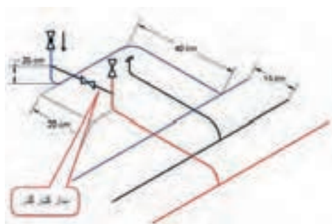
نمونه نحوه انشعاب گیری از خط اصلی
