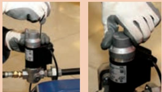
۱ پیچ قفل کننده روی کله هیدرولیک را یا به کمک آچار آلن شل کنید. این پیچ بدون لام خوردگی است.
