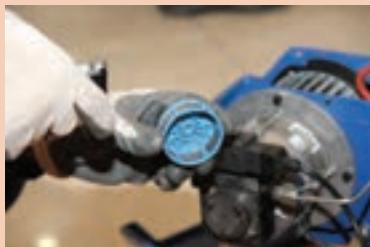
باز کردن در پوش پمپ و تمیز کردن فیلتر
