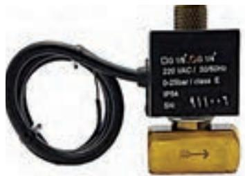
هنگام تعویض و یا نصب شیر برقی (نوع خطی) که بین نازل و پمپ قرار دارد به جهت عبور گازوئیل حک شده روی پایه آن طبق شکل ۲ دقت فرمایید.
