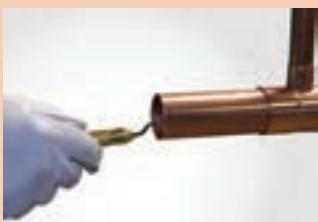
۱ با استفاده از لوله بر دوتکه لوله مسی به قطر ۸ میلیمتر و طول ۵۰ میلیمتر را برش بزنید.
