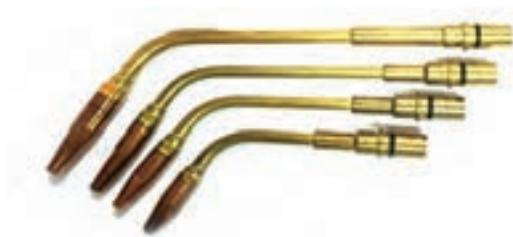
همراه هر دسته مشعل چند سرمتشعل جوشکاری با شماره‌های مختلف وجود دارد، سرمتشعل‌ها دارای شماره‌هایی هستند که روی سرمتشعل حک می‌شود و عموماً استاندارد خاصی ندارد و با توجه به ضخامت ورق با میزان مصرف گازها در ساعت شماره‌گذاری شده‌اند.
