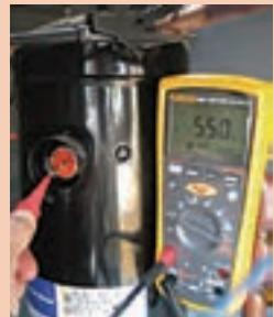
۳ آزمایش سالم‌بودن الکتروموتور فن (اتصال بدنه و سیم‌پیچ) را انجام دهید.
