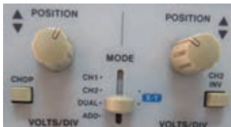
شکل ۶۳ - کلید معکوس کننده فاز کانال ۲
