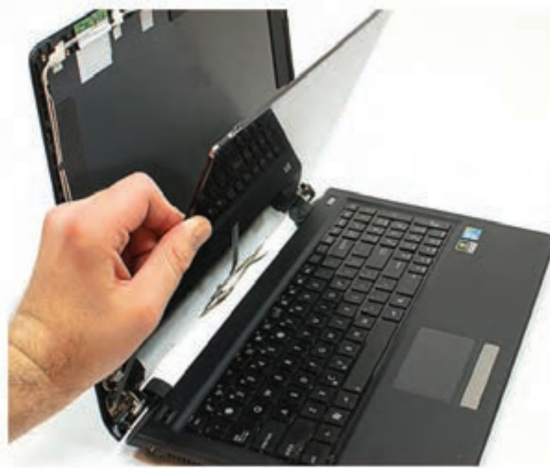
شکل ۵-۲۲- باز کردن نمایشگر لپ‌تاپ
