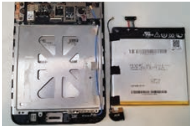
شکل ۳۰-۵- جدا کردن باتری از بدنه اصلی
