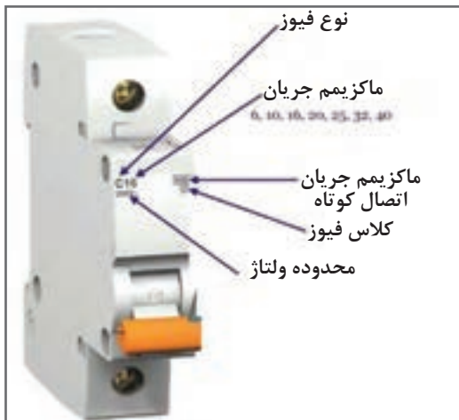
شکل ۱- مشخصات یک نوع فیوز مینیاتوری
