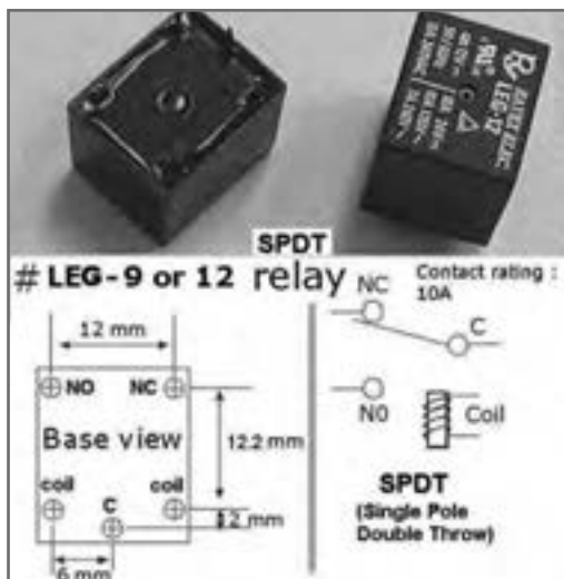
شکل ۴- مشخصات فنی یک نمونه رله
