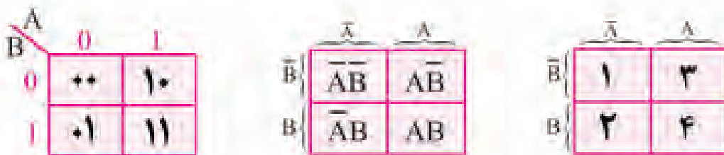
الف) هر خانه معرف ردیف در جدول (ب) هر خانه معرف مین ترم در هر ردیف (پ) هر خانه معادل عدد باینری هر ردیف شکل ۵-۷ - جدول کارنو
