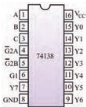
شکل ۷-۶- مشخصات پایه‌های آی سی ۷۴۱۳۸
