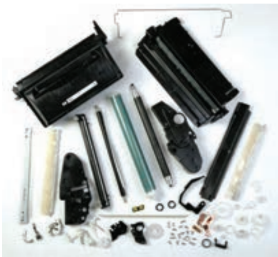
شکل ۲۸-۲ - قطعات تشکیل‌دهنده کارتریج All In One
