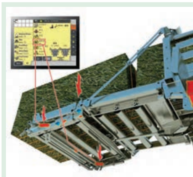
شکل ۴۹- کاربرد لودسل در بسته‌بند مکعبی
