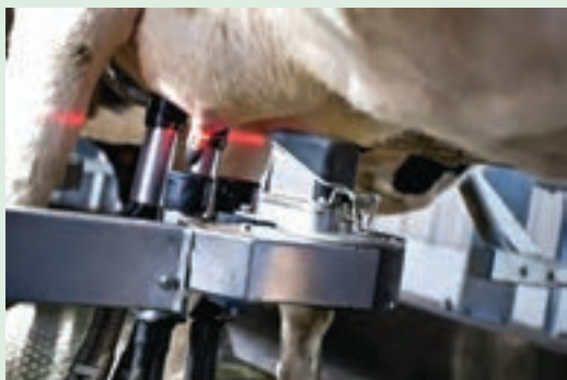
شکل ۵۴- شناسایی نوک پستان گاو با استفاده از دوربین سه بعدی و لیزر
