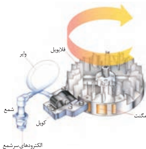
شکل ۷- طرز کار سیستم جرقه زنی
