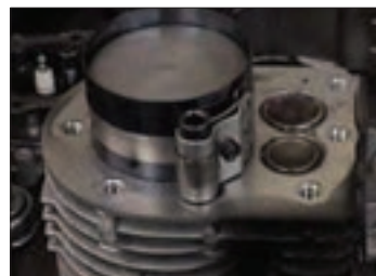
شکل ۳۲- جا زدن پیستون
