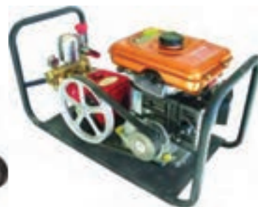
شکل ۱۹- انتقال قدرت در سم‌پاش‌های زنبه‌ای
