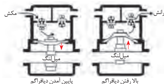
شکل ۴۱- طرز کار پمپ دیافراگمی
