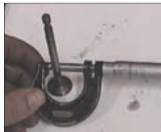
شکل ۲۹- اندازه‌گیری سوپاپ
