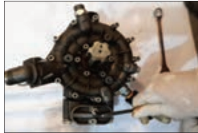
شکل ۴۸- باز کردن درپوش سوپاپ‌ها
