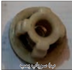
شکل ۵۰ - سوپاپ پمپ
